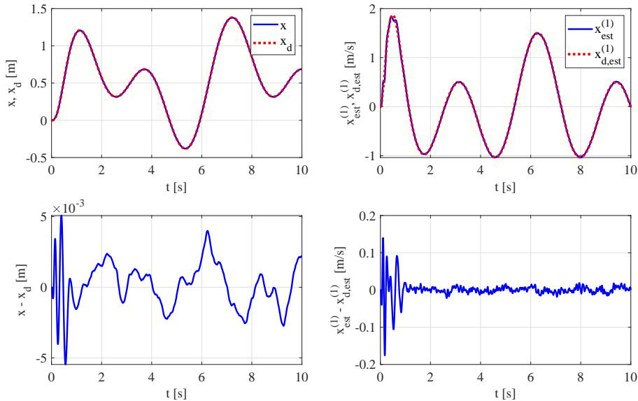
Slika 3.15: Odziv pozicije i estimirane brzine u slučaju estimiranih vrijednosti referentne trajektorije s parametrima  $a = 15, n = 15$  te dodanim šumom mjerena pozicije
