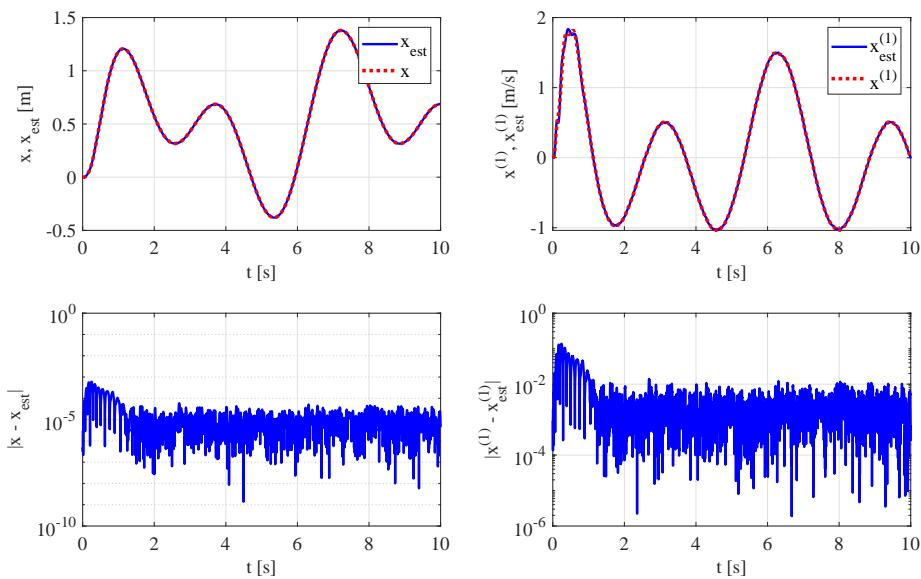
Slika 3.14: Usporedba poznate i estimirane vrijednosti  $x, \dot{x}$  uz estimiranu referentnu trajektoriju i parametre  $a = 15, n = 15$  te dodani šum mjerena pozicije
