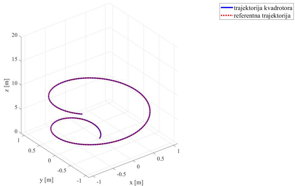
Slika 6.18: 3D prikaz slijedenje referentne trajektorije uz korištenje  $\hat{\bar{x}}_d, \hat{\bar{y}}_d$  i  $\hat{\bar{z}}_d$
