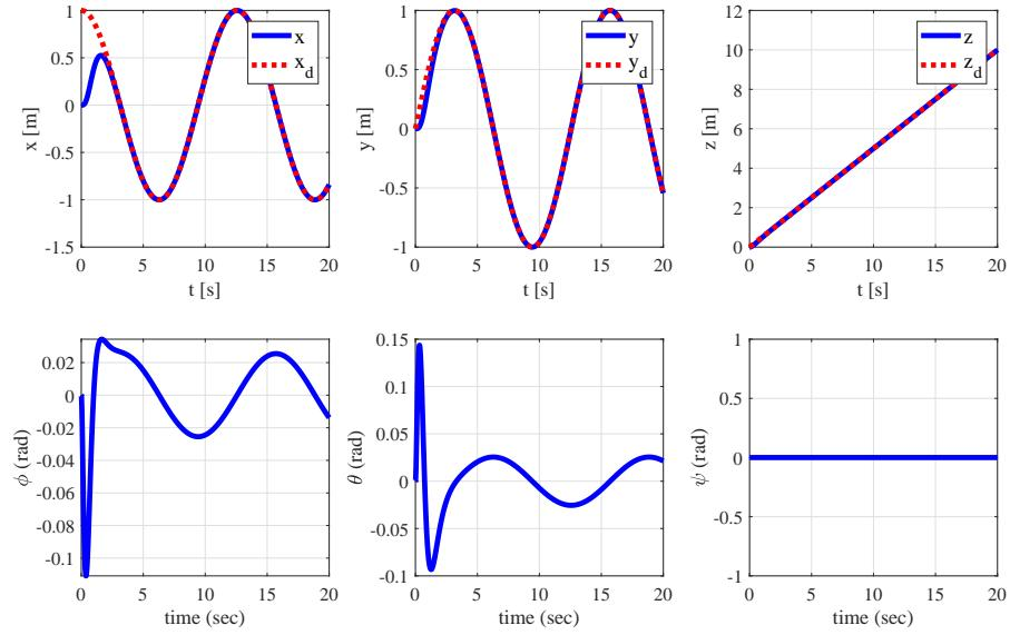
Slika 6.3: Slijedenje referentnih pozicija drona upravljanjem s estimiranim brzinama
