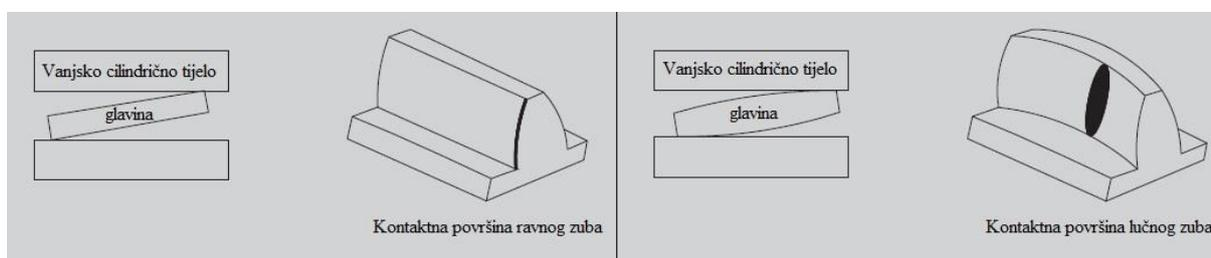
**Slika 19. Usporedba kontaktnih površina ravnih i kosih zubi [13]**
