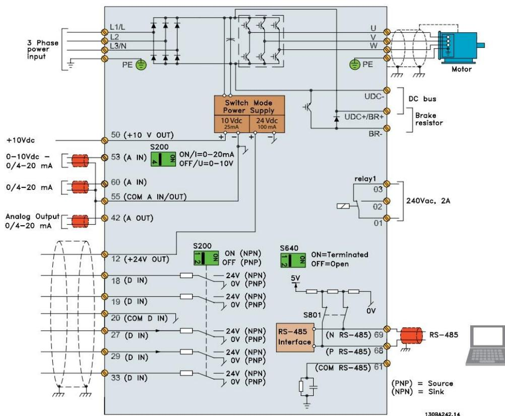
Slika 38. Prikaz ulaznih i izlaznih modula frekvencijskog pretvarača [25]
