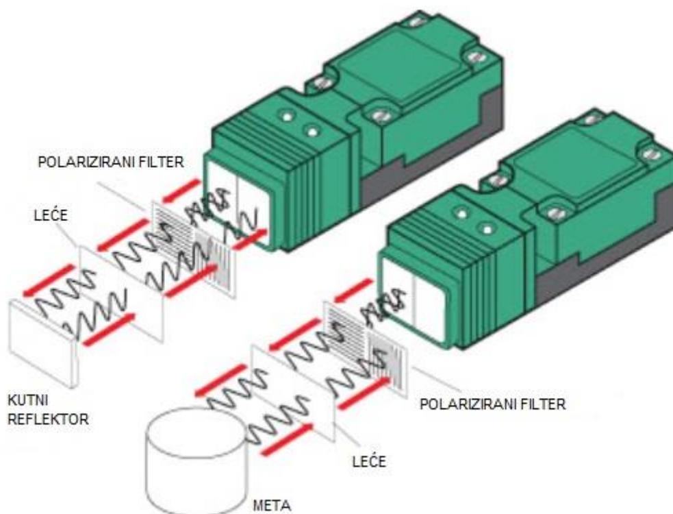
**Slika 23. Retro-reflektirajući senzor s polariziranim filterima [14]**
