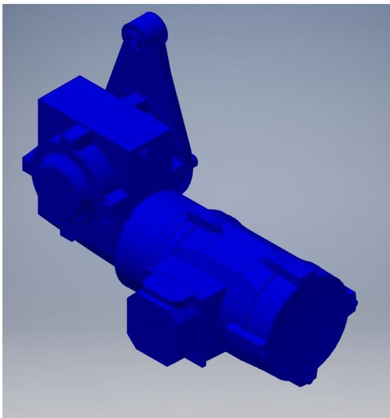
**Slika 12. Motor s reduktorom posipača brašna**
