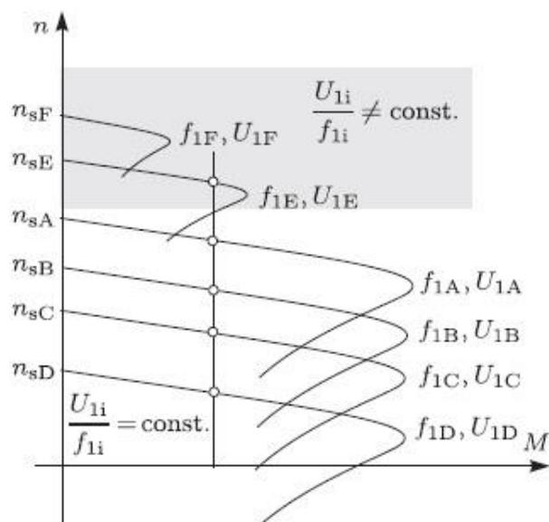
**Slika 36. Karakteristika asinkronog motora pri promjeni brzine vrtnje [24]**
