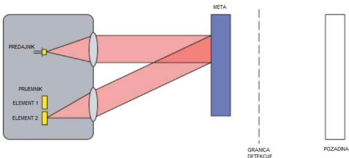
**Slika 22. Difuzni senzor s mehaničkim potiskivanjem pozadinskih smetnji [14]**
