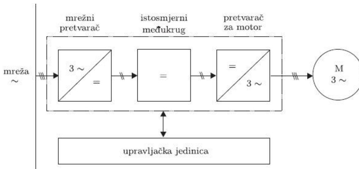
**Slika 35. Blok shema indirektnog frekvencijskog pretvarača [24]**
