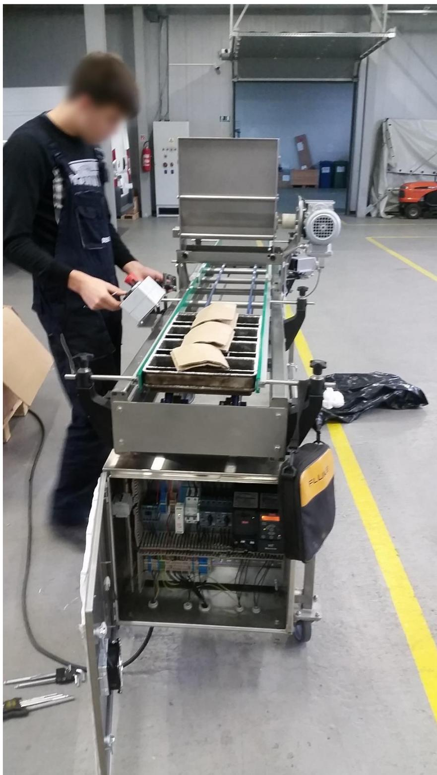
Slika 58. Ispitivanje funkcionalnosti transportnog uređaja
