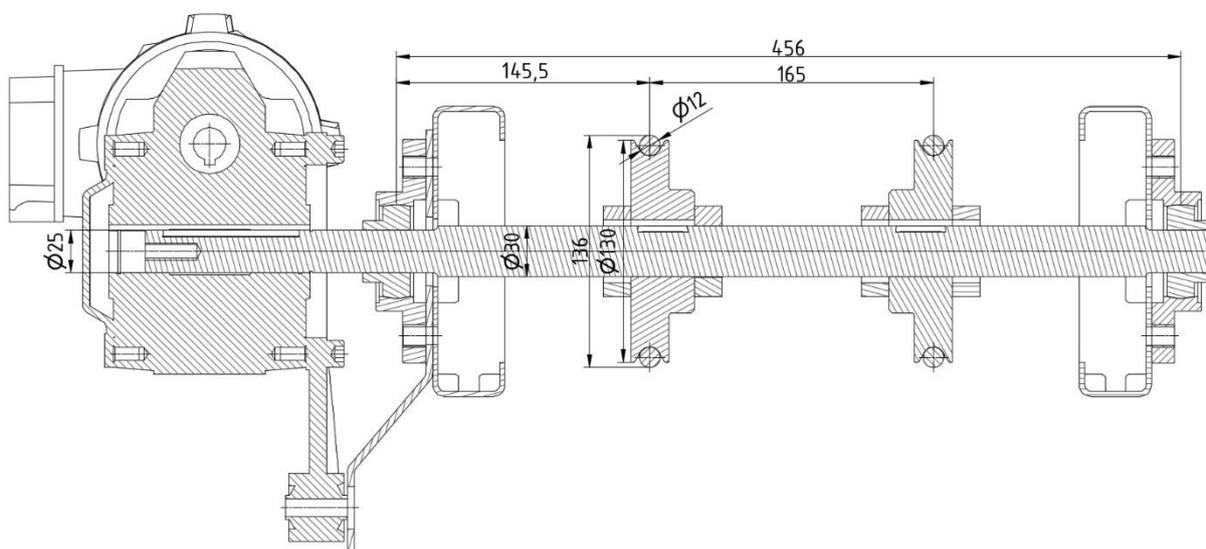
Slika 16. Presjek pogonskog dijela transportera
