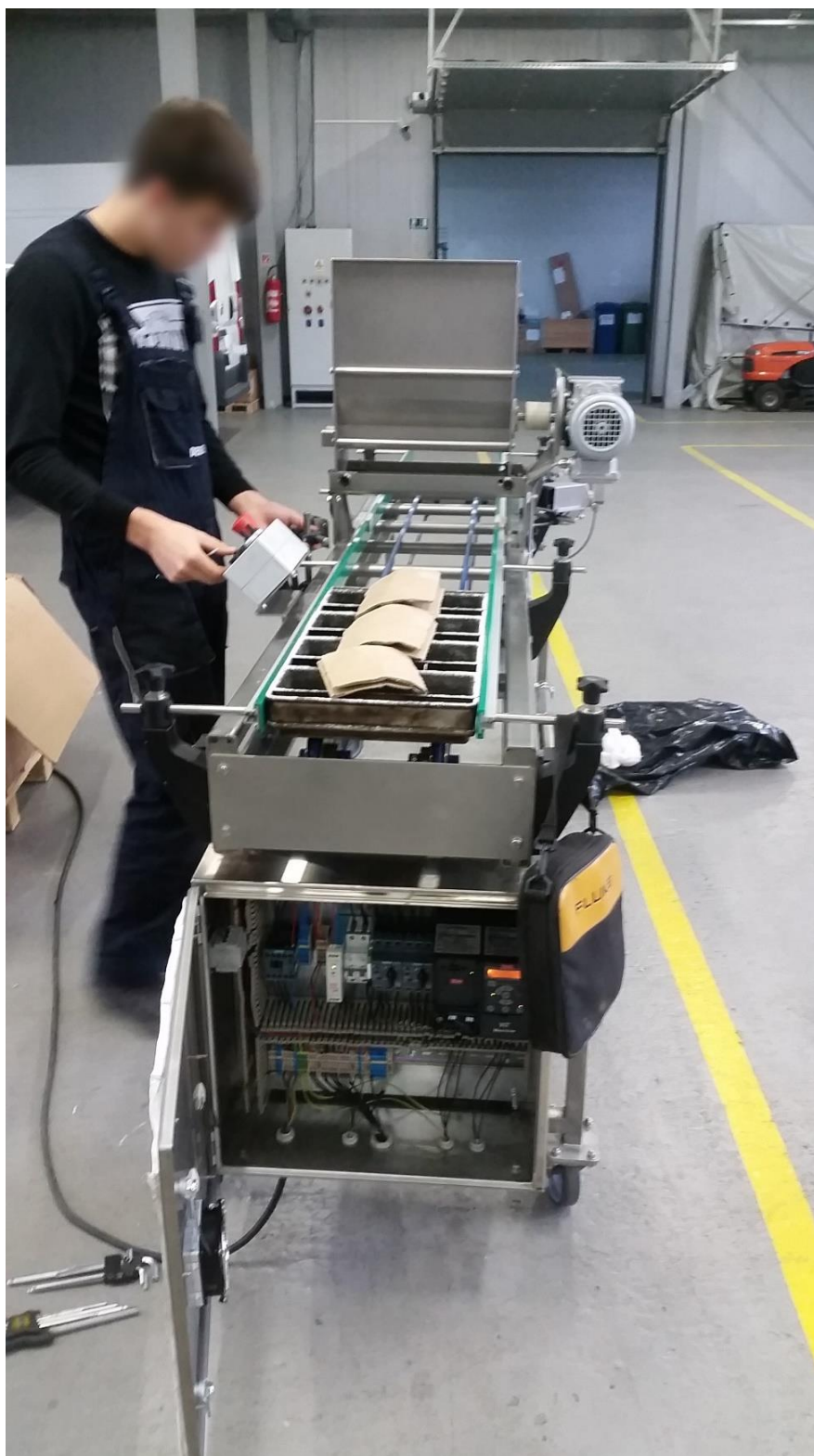
Slika 58. Ispitivanje funkcionalnosti transportnog uređaja
