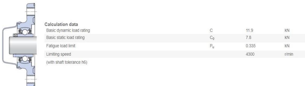
**Slika 14. Prikaz ležaja i parametara za kontrolni proračun [9]**
