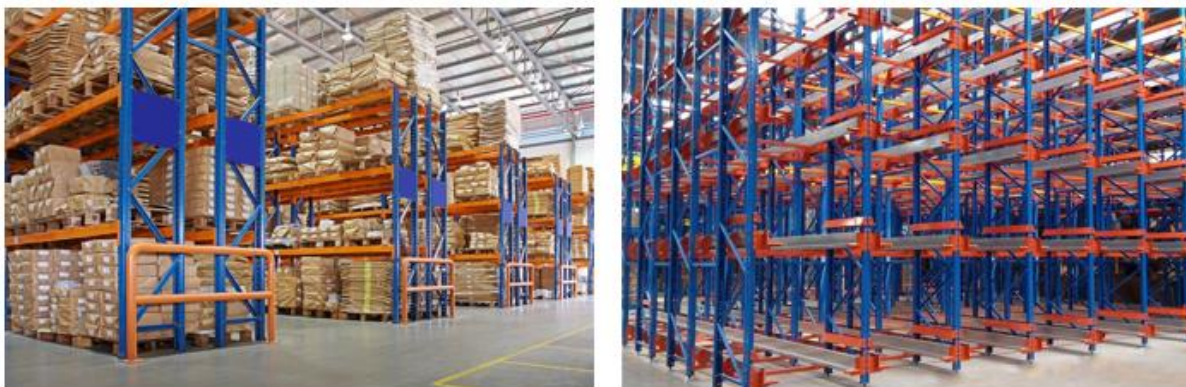
Slika 9. Usporedba klasičnog paletnog i Radio Shuttle regalnog sustava (izrađeno prema izvoru [9])
