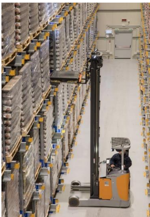
Slika 8. Visokoregalni viličar u suradnji s Radio Shuttle-om [7]
