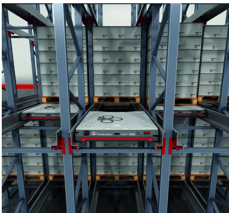
Slika 7. Prikaz Radio Shuttle regalnog sustava [7]
