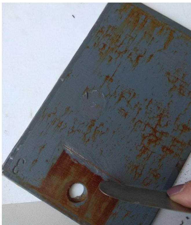
Slika 28. Uklanjanje premaza u području ureza
