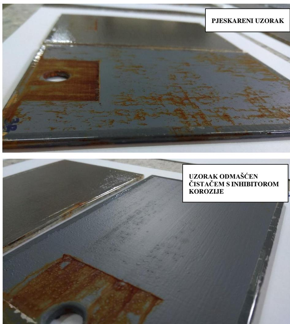
**Slika 61. Mjehuravost i korodiranje površine Chromos vodenog premaza**
