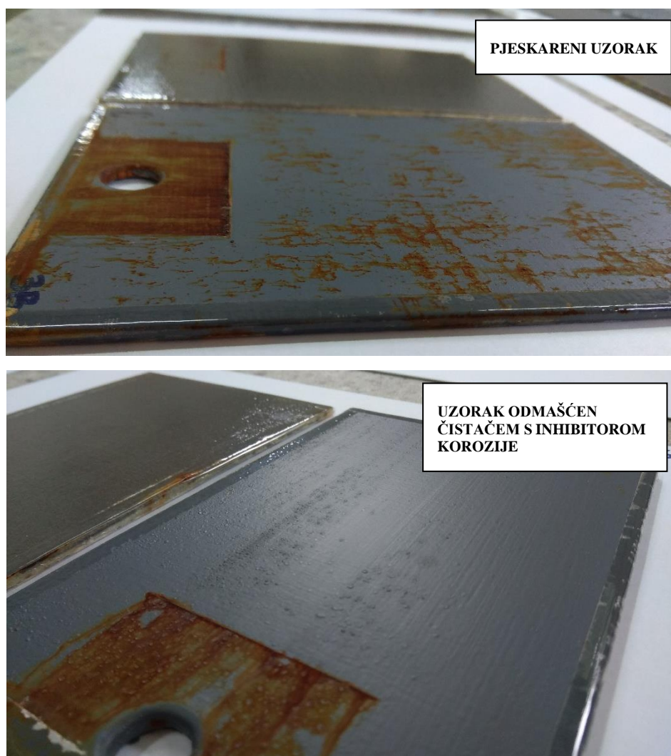
Slika 61. Mjehuravost i korodiranje površine Chromos vodenog premaza
