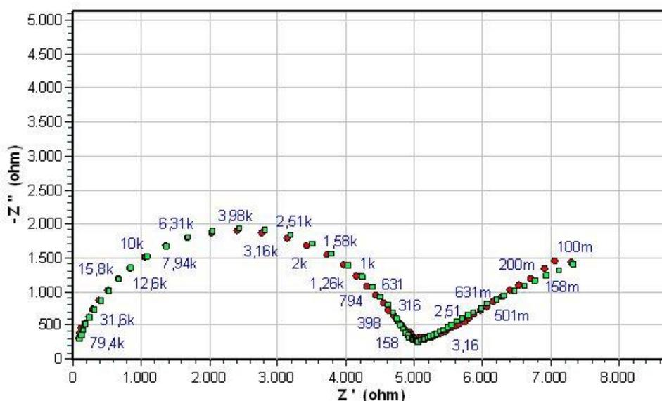
**Slika 62. Nyquistov dijagram za Chromos vodeni premaz, dobiven ispitivanjem uzorka pripremljenog pomoću čistača s nižom koncentracijom inhibitorom VpCI-416, nakon 168 h izlaganja 3,5% -tnoj otopini NaCl**
