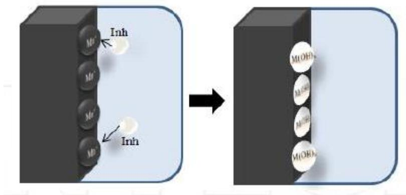
Slika 18. Mehanizam djelovanja katodnih inhibitora [17]
