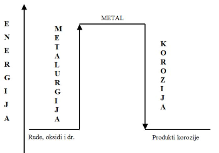
Slika 1. Energetska promjena prilikom prerade i korozije metala [3]
