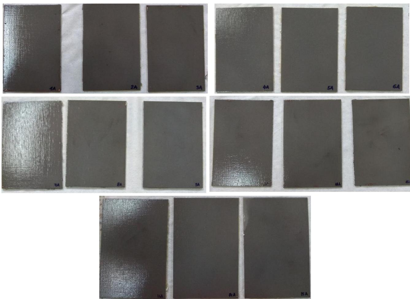
**Slika 46. Uzorci premazani s akrilnim premazom VpCI – 386 (manja koncentracija) prije ispitivanja**
