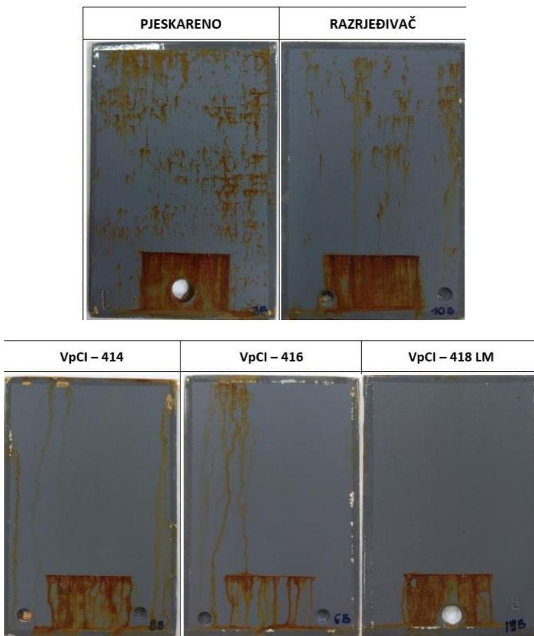
**Slika 60. Uzorci nakon 96 h ispitivanja u slanoj komori – Chromos vodeni premaz (manja koncentracija inhibitora korozije)**
