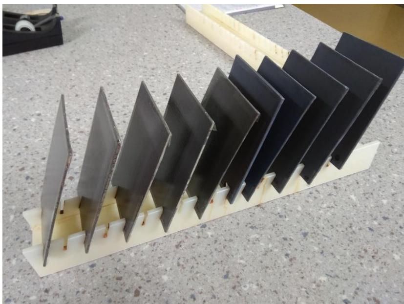
**Slika 48. Uzorci postavljeni na stalak za vlažnu komoru**
