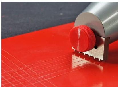
**Slika 4. Ispitivanje prionjivosti zarezivanjem mrežice (“Cross-cut test”)**
