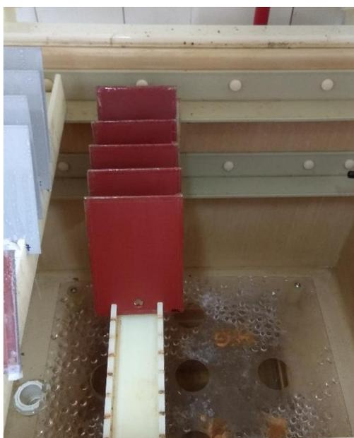
**Slika 75. Uzorci premazani Chromos epoksi premazom – vlažna komora**
