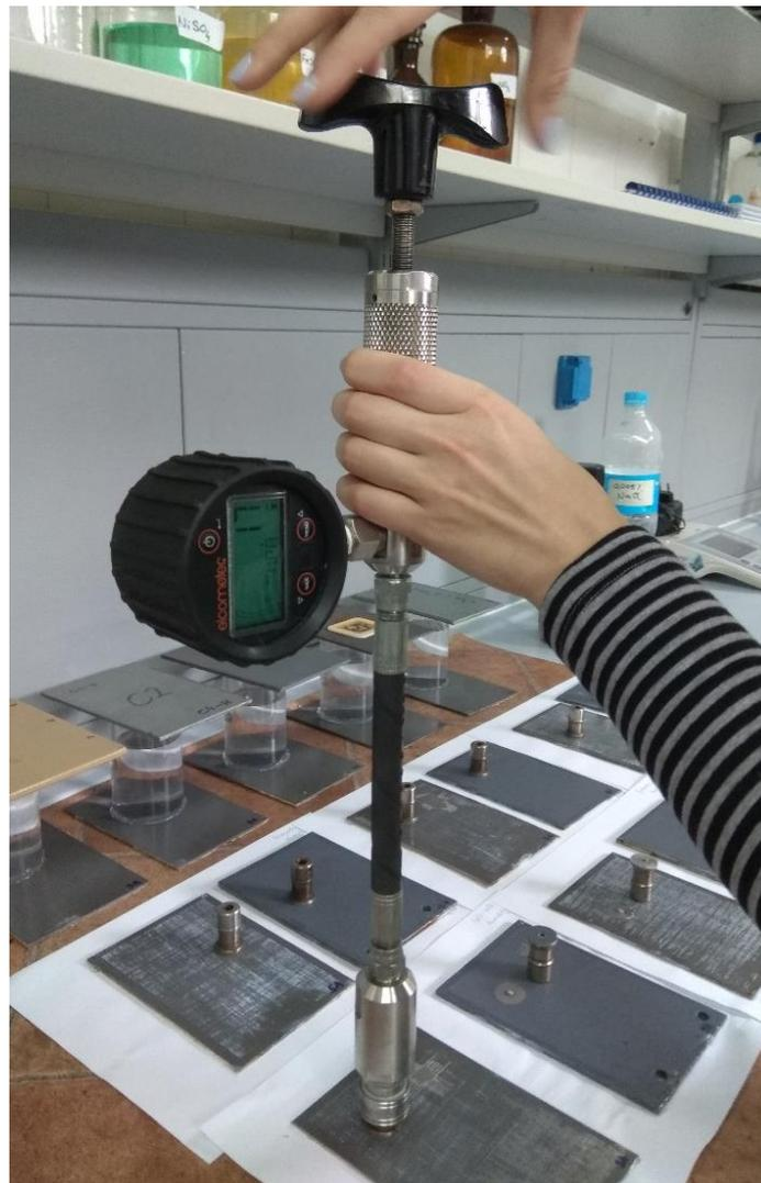
**Slika 32. Ispitivanje prionjivosti vlačnom metodom, HRN EN ISO 4624**
