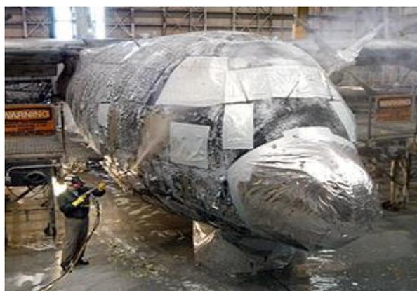
**Slika 22. Primjena inhibitora korozije u zrakoplovstvu [25]**
