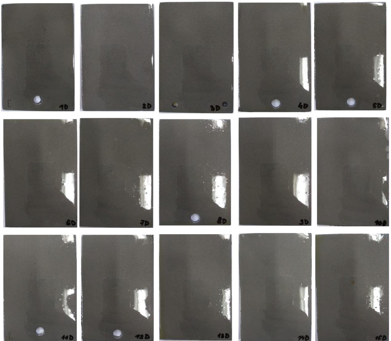
Slika 80. Uzorci zaštićeni VpCI-2026 premazom prije ispitivanja
