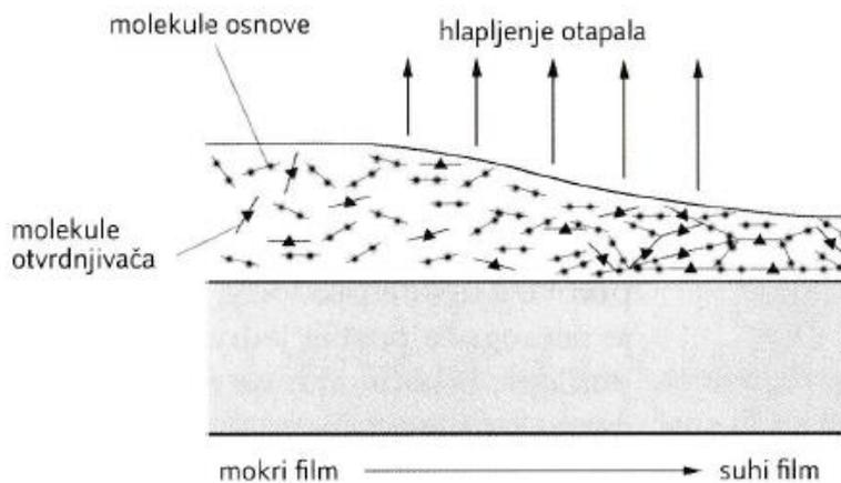
Slika 9. Dvokomponentno sušenje [8]
