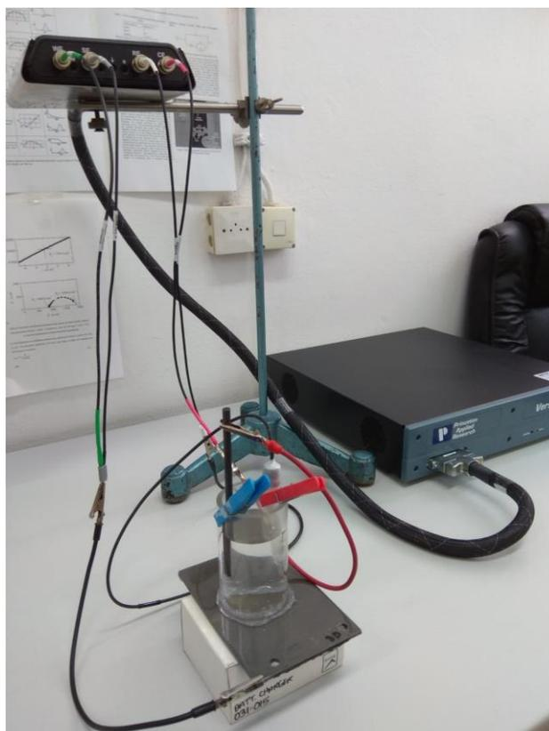
Slika 54. Ispitna ćelija i uređaj za ispitivanje
