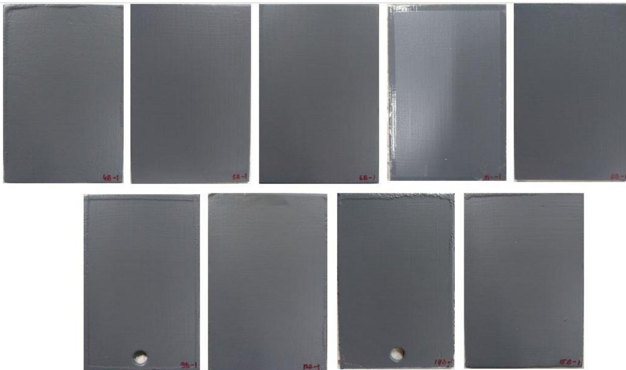
**Slika 68. Uzorci premazani s Chromos vodenim premazom (veća koncentracija) prije ispitivanja**
