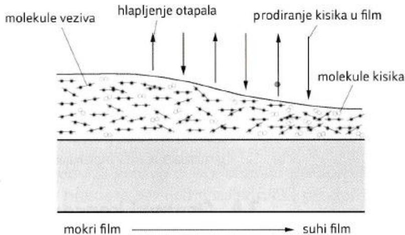
Slika 8. Oksidacijsko sušenje [8]
