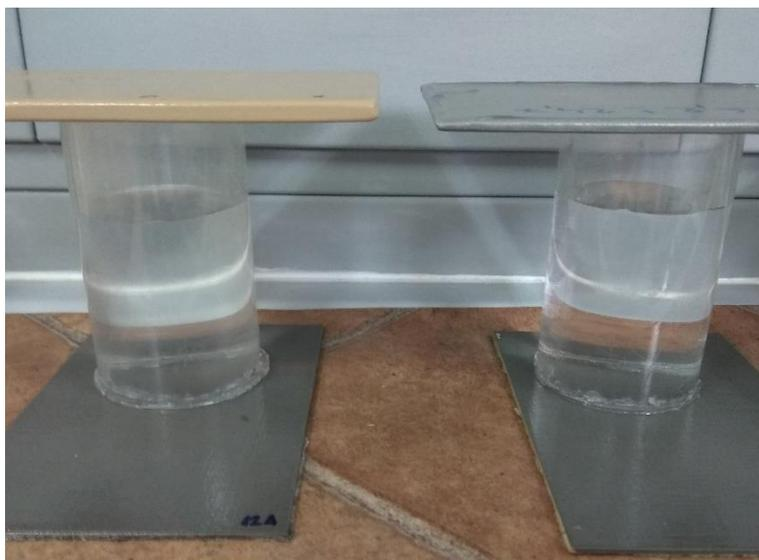
Slika 53. Izlaganje uzoraka otopini 3,5 %-tnog NaCl
