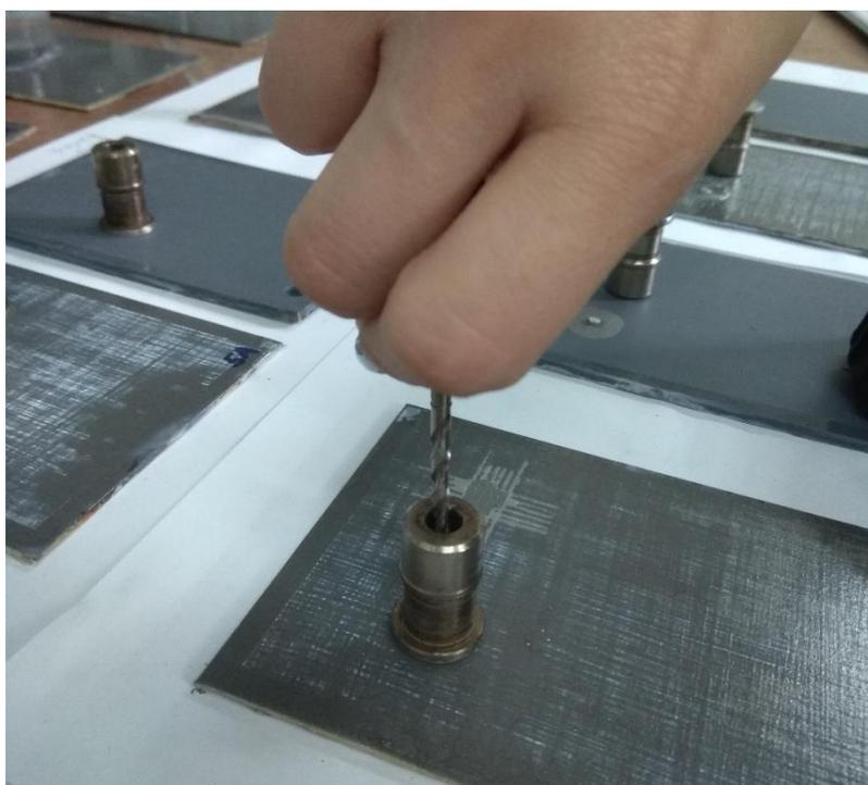
**Slika 31. Ispitivanje prionjivosti vlačnom metodom - uklanjanje viška ljepila**
