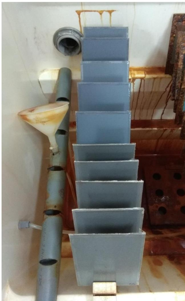
**Slika 50. Postavljanje uzoraka na stalak u slanu komoru**
