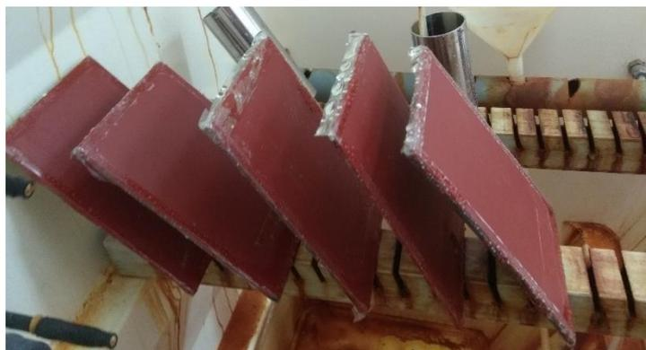
**Slika 77. Uzorci premazani Chromos epoksi premazom – slana komora**
