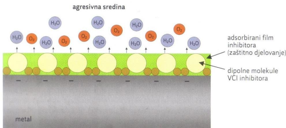
Slika 19. Mehanizam djelovanja hlapivih inhibitora korozije [8]
