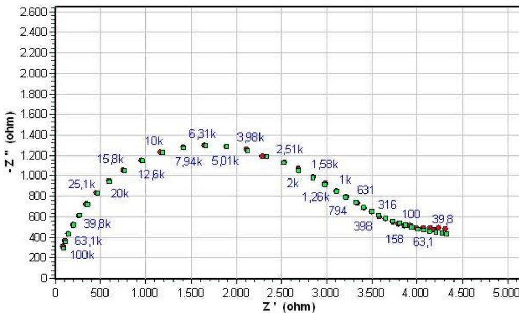
**Slika 72. Nyquistov dijagram za Chromos vodeni premaz, dobiven ispitivanjem uzorka pripremljenog pomoću čistača s većom koncentracijom inhibitorom VpCI-414, nakon 168 h izlaganja 3,5% -tnoj otopini NaCl**
