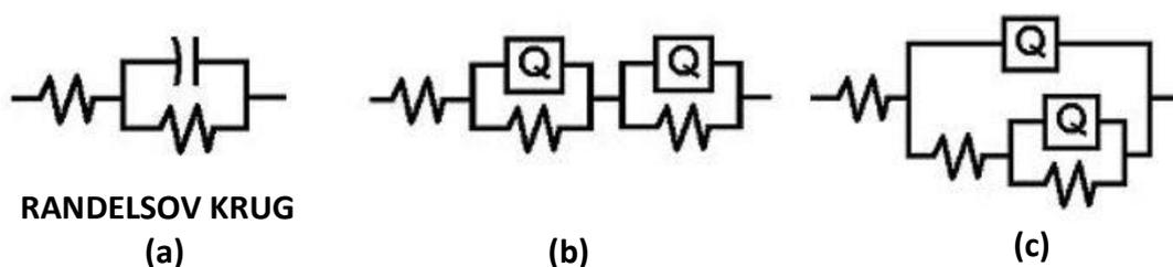
**Slika 52. Ekvivalentni električni krugovi korišteni za opisivanje impedancijskih spektara za: (a) nov neporozan premaz; (b) porozan premaz gdje je došlo do korozije podloge; (c) porozan premaz**
