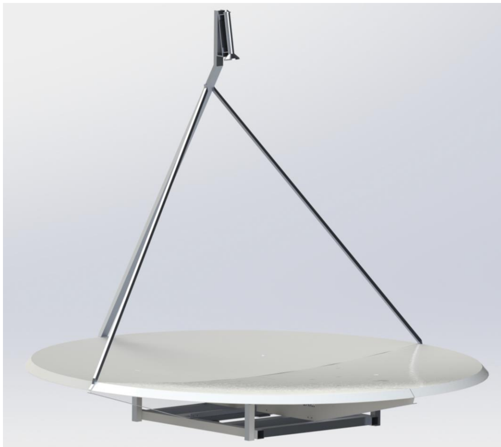
Slika 3.2 SolidWorks model tanjura antene
