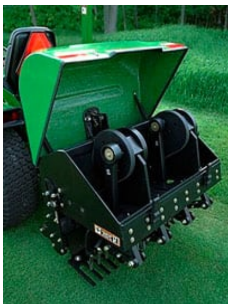
Slika 24. Transformacija rotacijskog gibanja u linearno – John Deere [22]
