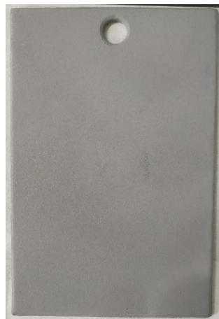
**Slika 14. Pjeskarena pločica**
