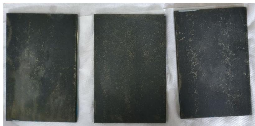
**Slika 18. Pločice nakon tretiranja sumpornom kiselinom**
