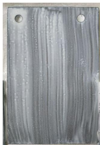
**Slika 15. Pločica premazana CorrVerter®-om**
