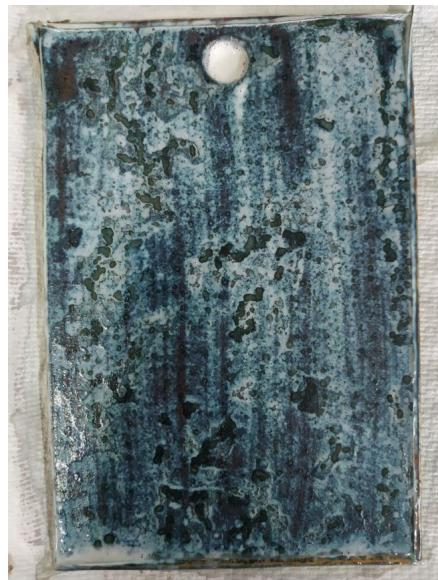
**Slika 19. Pločica korodirane površine premazana CorrVerter®-om**
