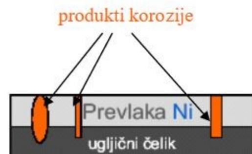
Slika 11. Katodna prevlaka nikla na čeliku [9]
