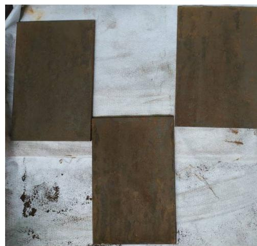
**Slika 17. Pločice prije uranjanja u sumpornu kiselinu prekrivene korozijskim produktima**
