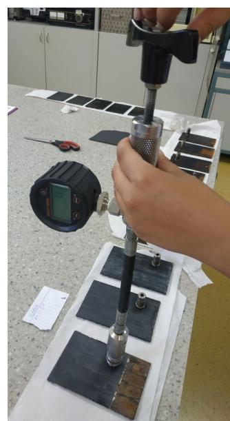
Slika 28. Postupno povećanje sile pri vlačnoj metodi
