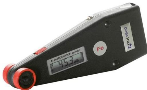
**Slika 21. QuaNix 1500 uređaj za mjerenje debljine zaštitnog premaza**
