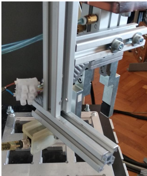
Slika 13. Montaža senzora na pneumatsku hvataljku
