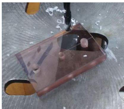
Slika 15. Akrilne pločice za montažu hvataljke
