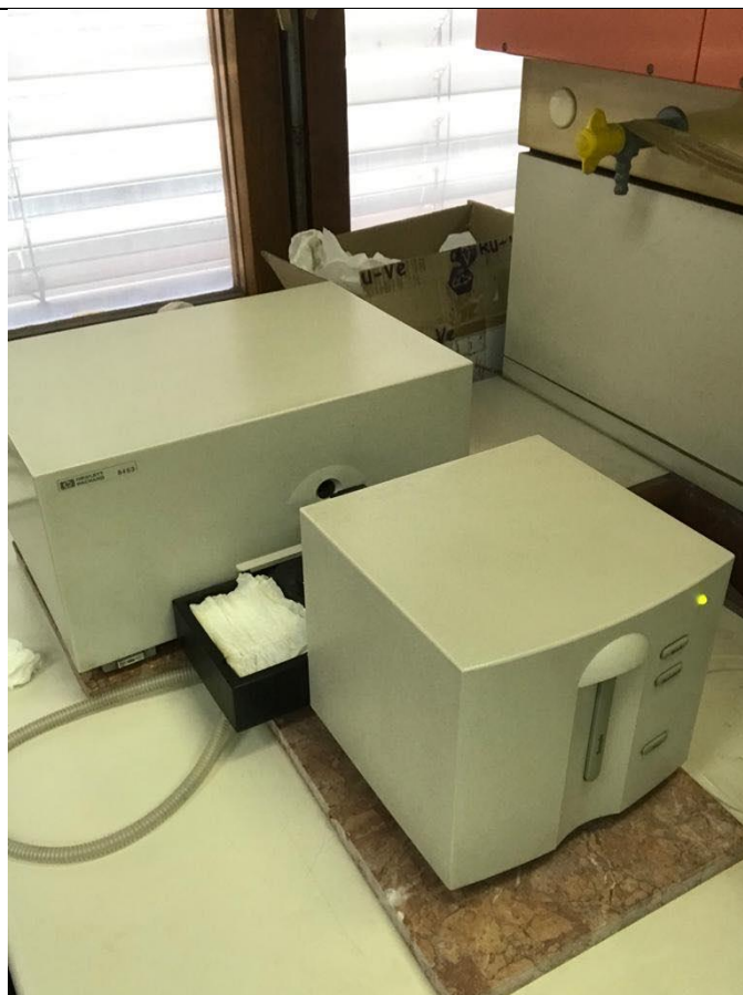
Slika 6. Spektrofotometar Hewlett Packard, model 8453 (Hewlett Packard, SAD)
