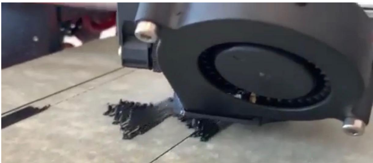
Slika 24. Slabo lijepljenje prvog sloja
