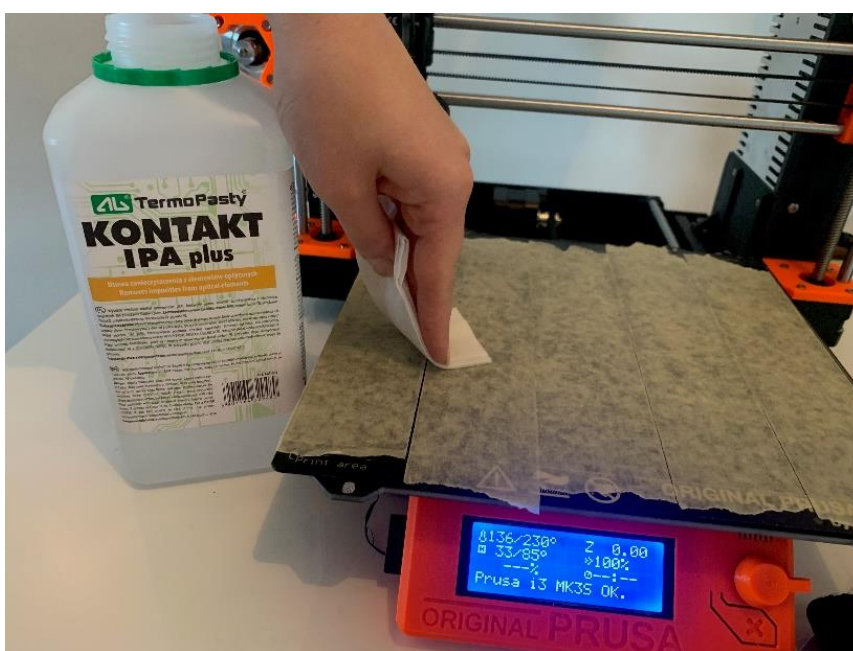
Slika 22. Priprema površine platforme za 3D ispis
