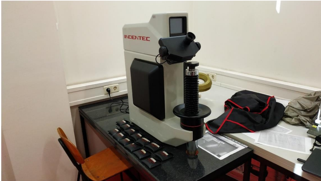
Slika 24. Identec uređaj za mjerenje tvrdoće
