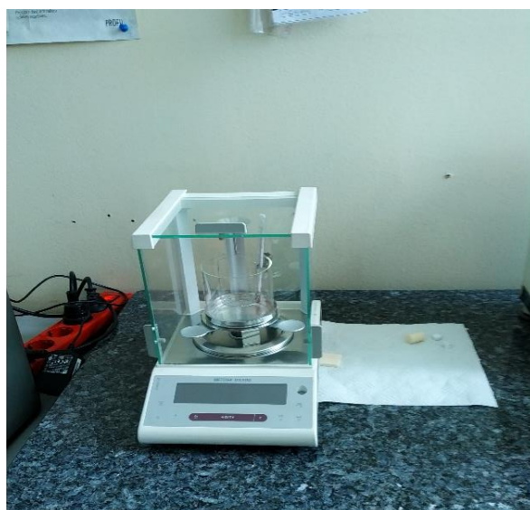
Slika 20. Analitička vaga Mettler Toledo JP703C
