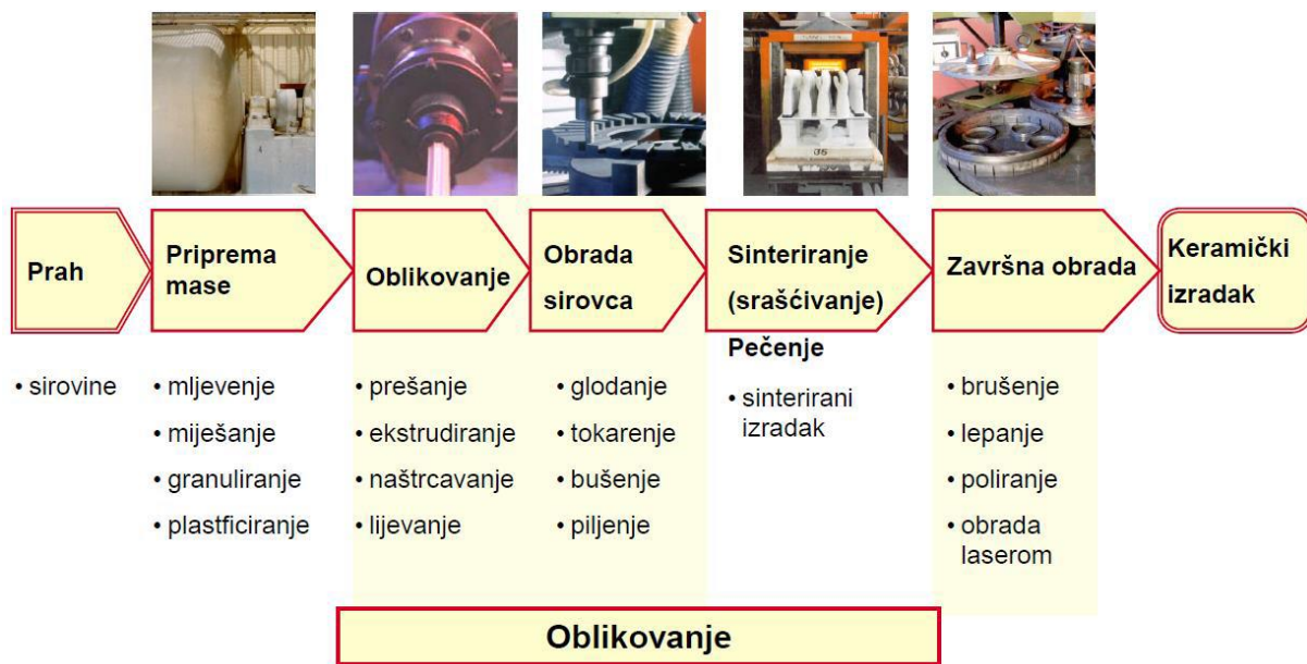
Slika 5. Bitne faze u procesu proizvodnje keramike [12]
