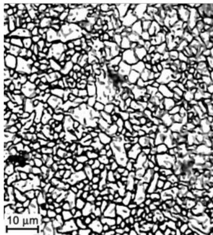
Slika 2. Mikrostruktura mikroznate aluminij oksidne keramike [1]
