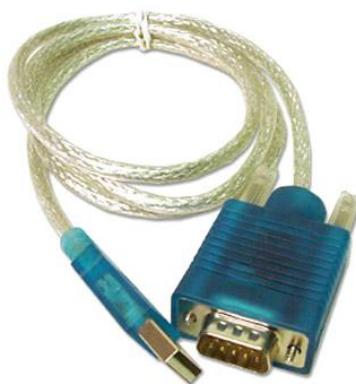
Slika 2.10. Kabel za spajanje robota s računalom [8]
