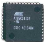
Slika 2.12. 8 - bitni mikrokontroler AT89C51ID2
