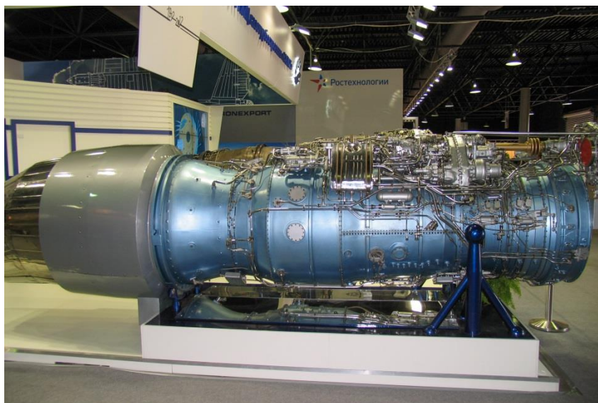
Slika 2.4. AL-31FM2 zrakoplova Chengdu J-20
