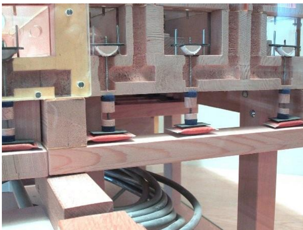
Slika 15. Prikaz pneumatske zračnice s čunjastim ventilima u presjeku
