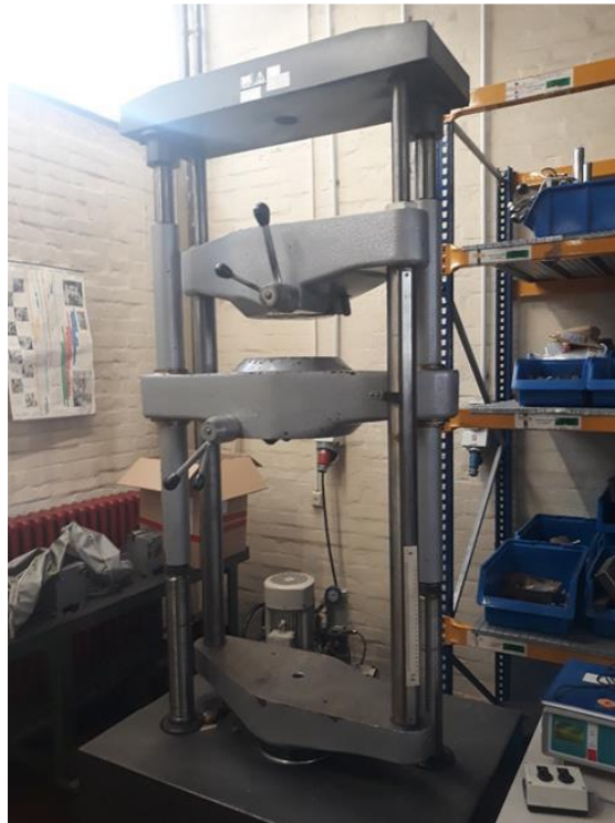
Slika 13: Kidalica EU 40 MOD[5]
