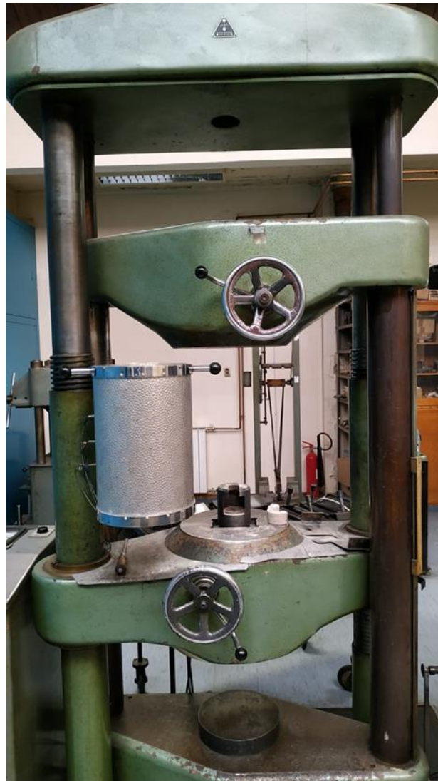
Slika 16. Kidalica tijekom izmjene epruveta
