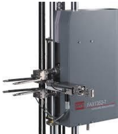
Slika 10: Automatski kontaktni ekstenzometar [7]
