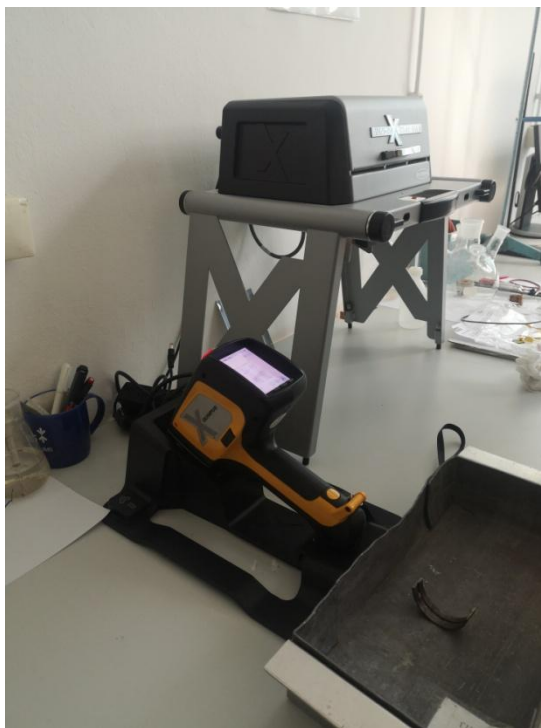
Slika 22. Prijenosni XRF spektrometar
