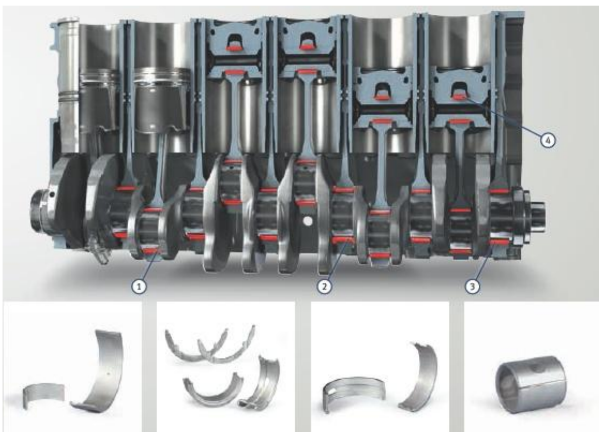
Slika 19. Primjer motora s različitim vrstama kliznih ležaja
