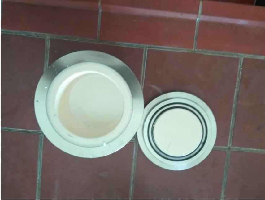
Slika 17. Posuda za homogenizaciju čija je obloga izrađena od Al_2O_3 keramike unutar koje je suspenzija
