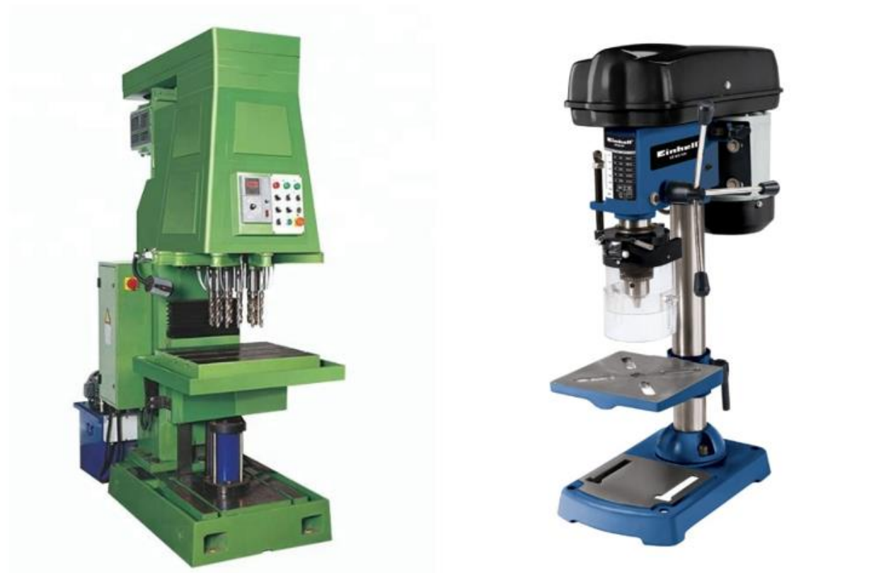
Slika 3. Viševretena i stapna bušilica
