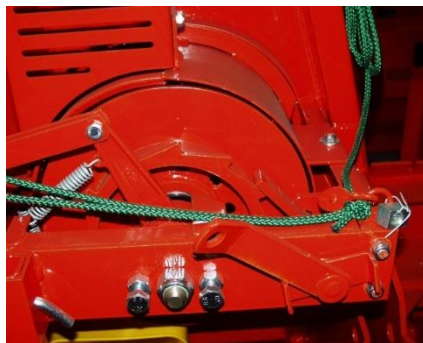
Slika 16. Mehanizam spojke i zadržlača
