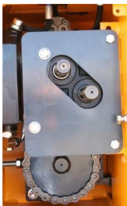
Slika 12. Dva kardanska priključka
