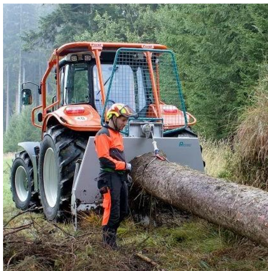
Slika 1. Prikaz traktorskog vitla u radu
