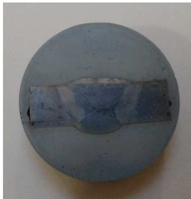
Slika 73. Izbrusak zavarenog spoja pripremljen za mjerenje tvrdoće
