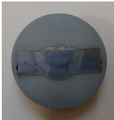
Slika 73. Izbrusak zavarenog spoja pripremljen za mjerenje tvrdoće
