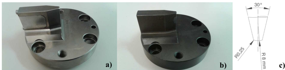
Slika 12. Instrumentirani nož polumjera oštrice 8 mm a); klasični nož polumjera oštrice 8 mm b); geometrija oštrice noža c)
