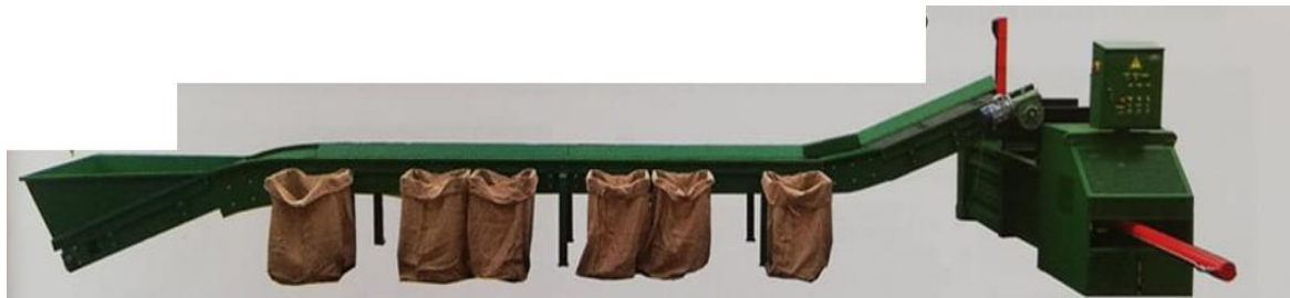
Slika 14. Ručna sortirnica s tri radna mjesta [1]
