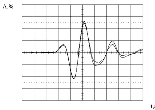
**Slika 5. Postupak rada metodom preklapanja dvaju impulsa**
