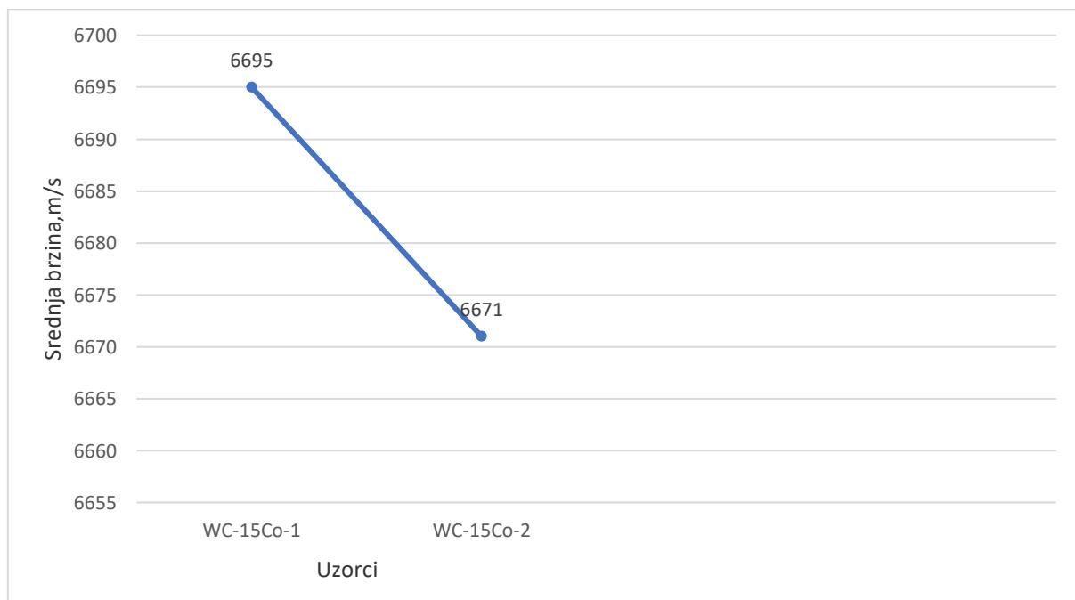
**Slika 12. Prikaz srednje brzine uzorka s 15% Co**
