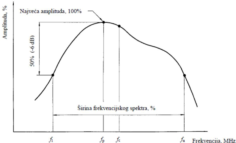
**Slika 7. Frekvencijski spektar ultrazvučnog impulsa [4]**
