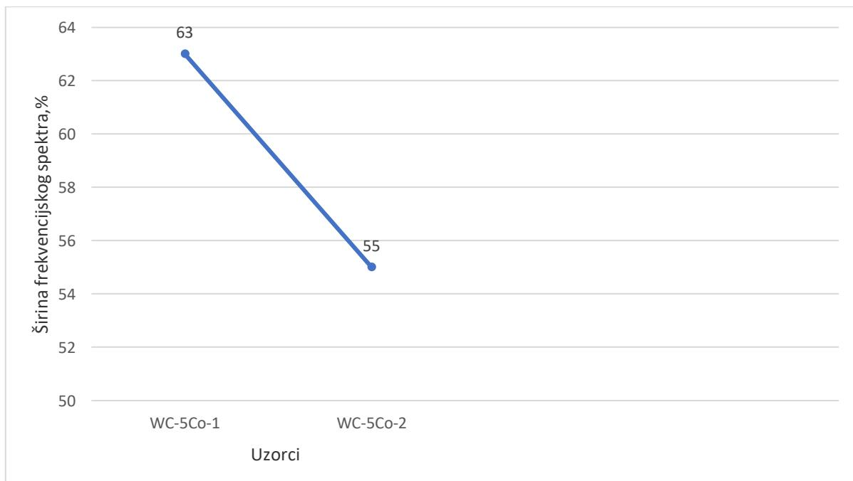
**Slika 15. Prikaz širine frekvencijskog spektra uzorka s 5% Co**
