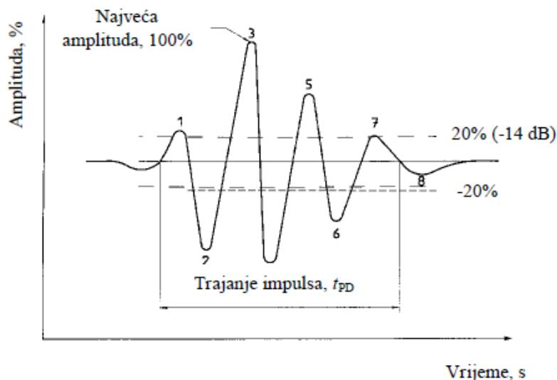
Slika 6. Valni oblik ultrazvučnog impulsa u vremenskoj domeni [4]
