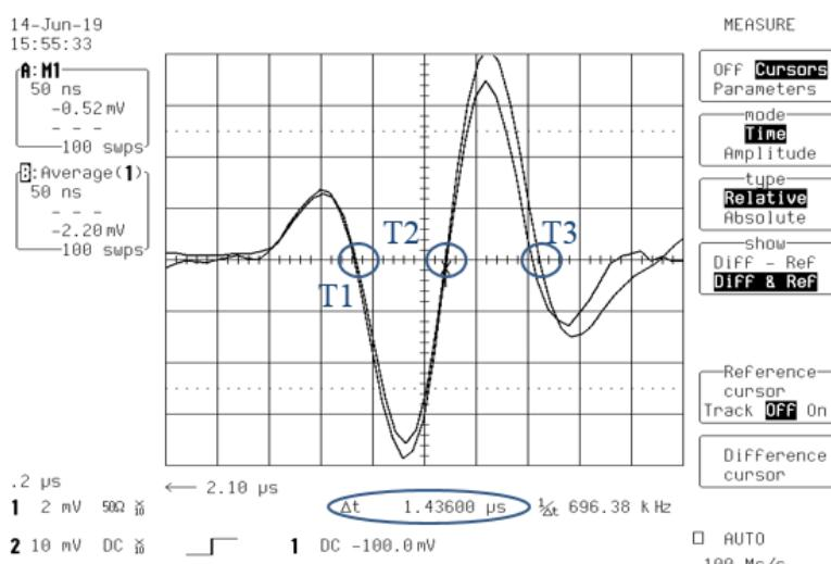
**Slika 9. Postupak rada metodom preklapanja ultrazvučnih signala na uzorku WC-5Co-1: prikaz dvaju preklopljenih signala i njihove razlike u vremenu proleta**
