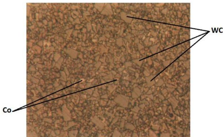
Slika 8. Mikrostruktura nanostrukturiranog tvrdog metala WC – Co [9]
