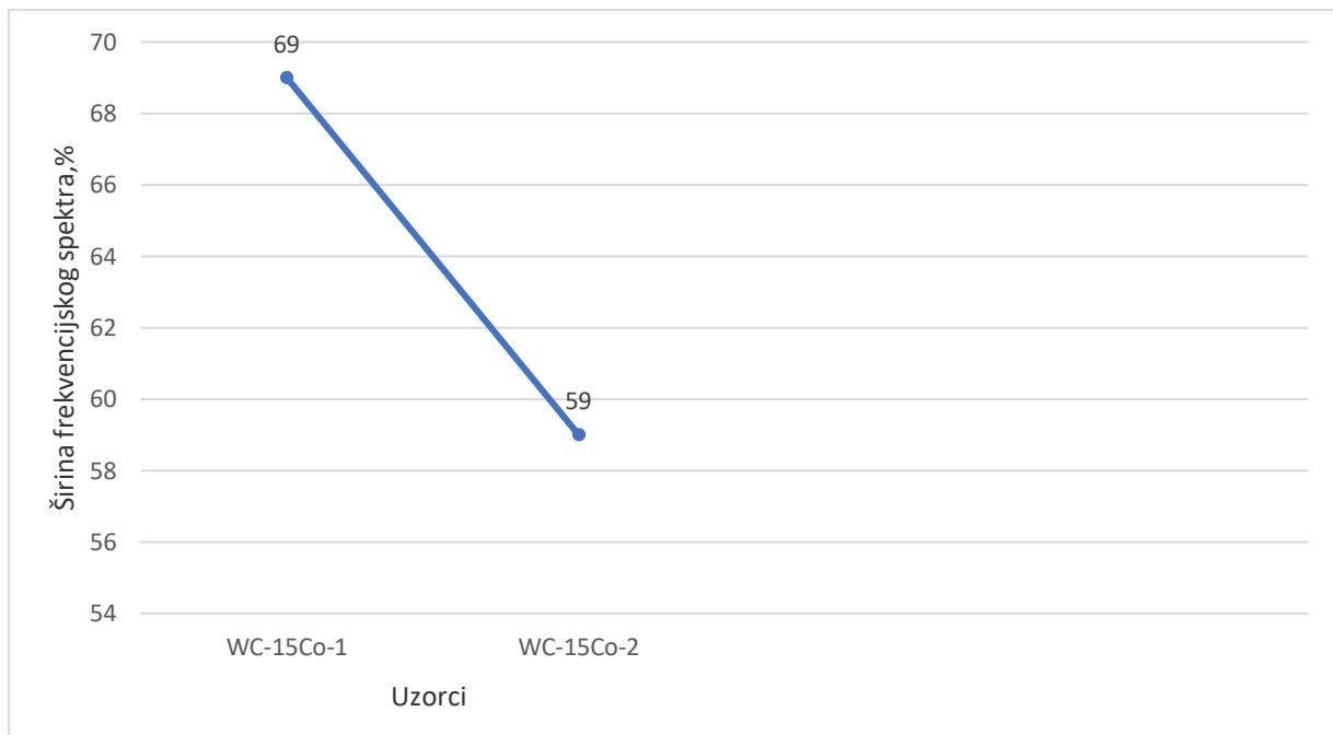
**Slika 16. Prikaz širine frekvencijskog spektra uzoraka s 15% Co**
