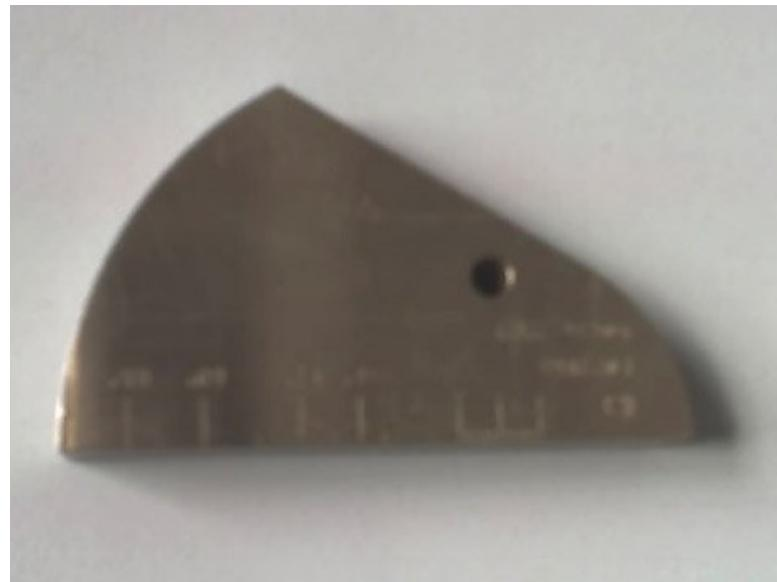
Slika 9. Referentni etalon V2
