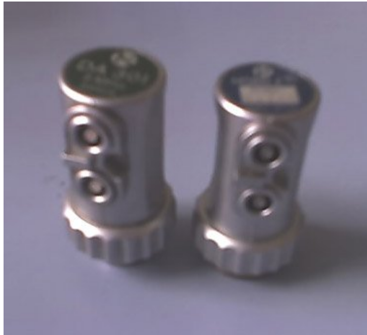
Slika 7. Prikaz dvije dvostruke sonde
