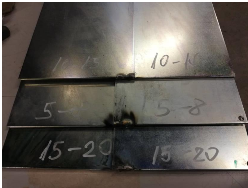
Slika 28 Limovi spremni za zavarivanje
