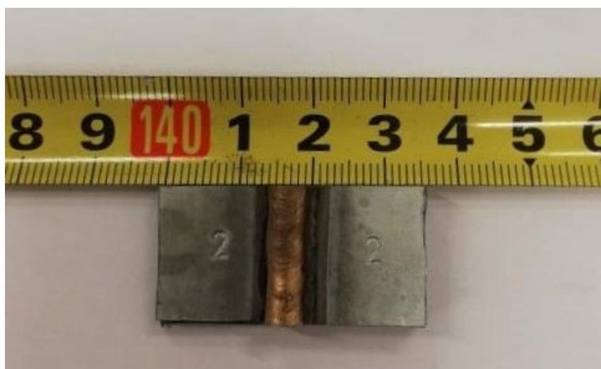
Slika 38 Naličje zavara uzorka 2
