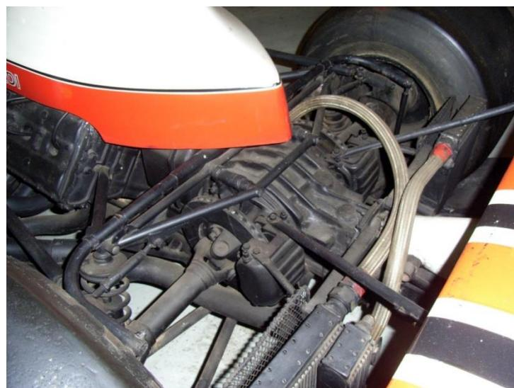
Slika 7. Kočnice unutar bolida na McLarenu M23 [6]
