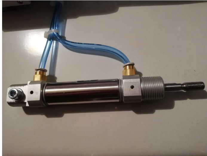
Slika 2.10. Aktuator C85N20 – 40* - XB6
