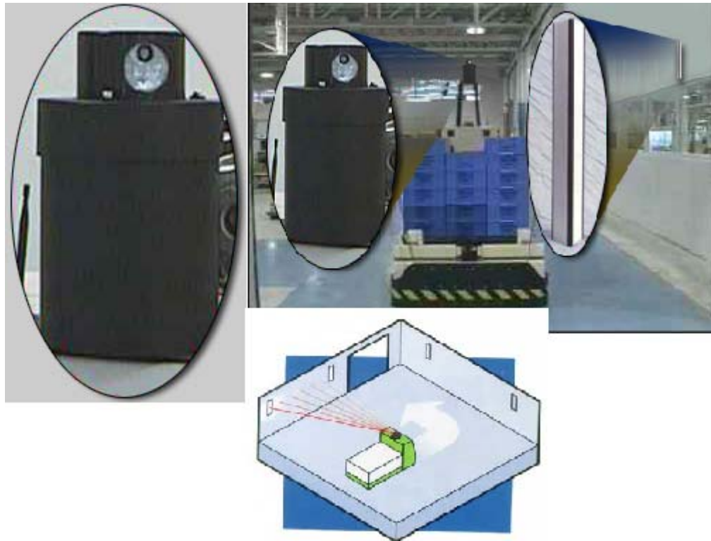
Slika 13. Primjer navigacije laserom kod AGV-a
