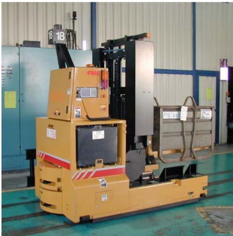
Slika 33. AGV pri transportu poluproizvoda u tvornicama
