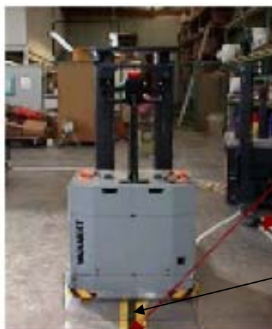
Slika 11. Indukcijski vođeno vozilo
