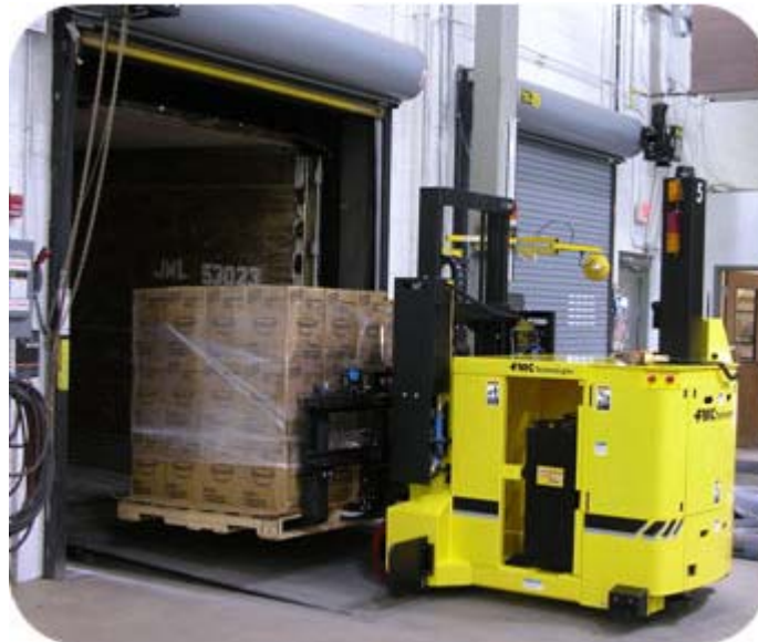
Slika 40. AGV prilikom utovara u kamion
