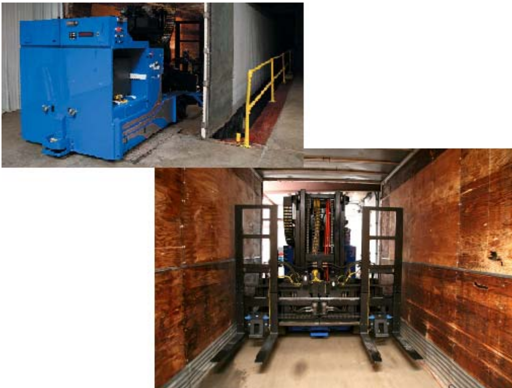
Slika 43. SMART LOADER-a prilikom ulaska u kamion
