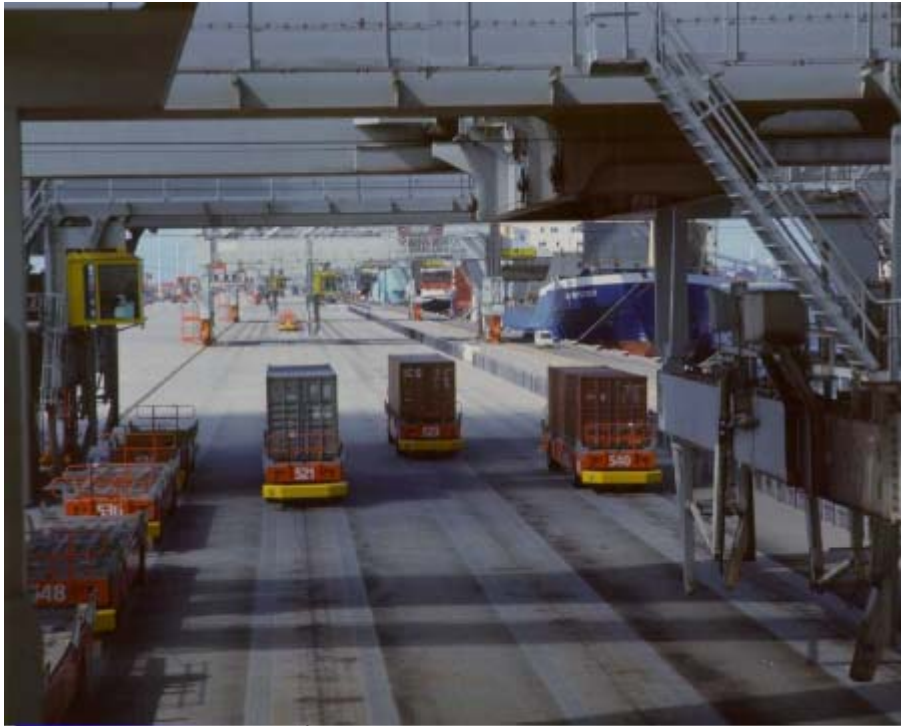
Slika 36. AGV vozila u lukama za transport kontejnera
