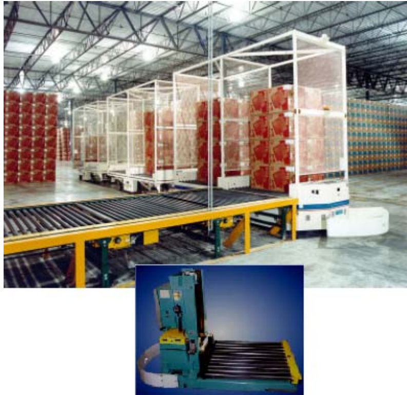
Slika 25. Primjer vozila s valjkastim konvejerom
