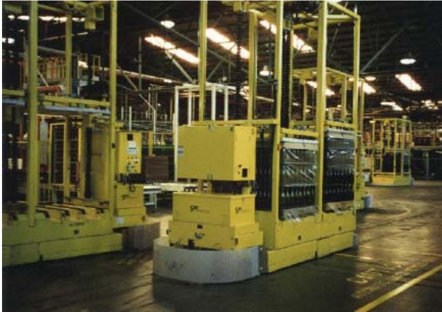
Slika 26. AGV vozilo s liftom za podizanje i istovar tereta
