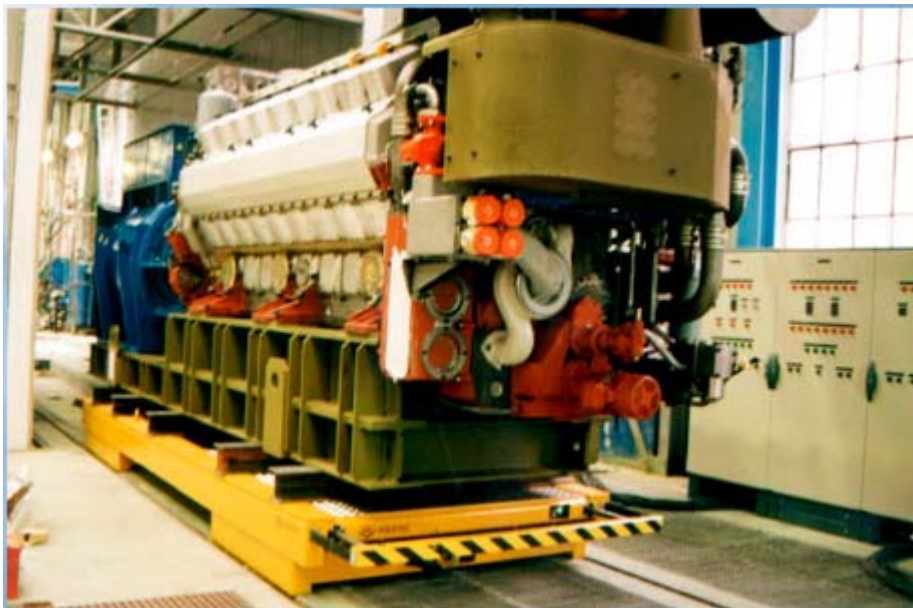
Slika 34. Vozilo za teške terete
