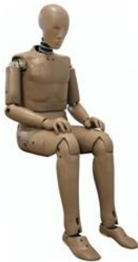
Slika 6. Hybrid III "crash" test lutka [13]
