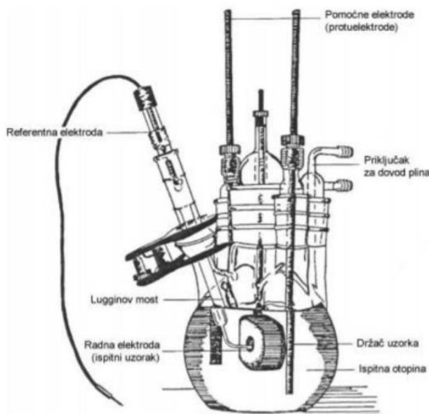
**Slika 4.1 Elektrokemijska čelija za korozijska ispitivanja[23]**
