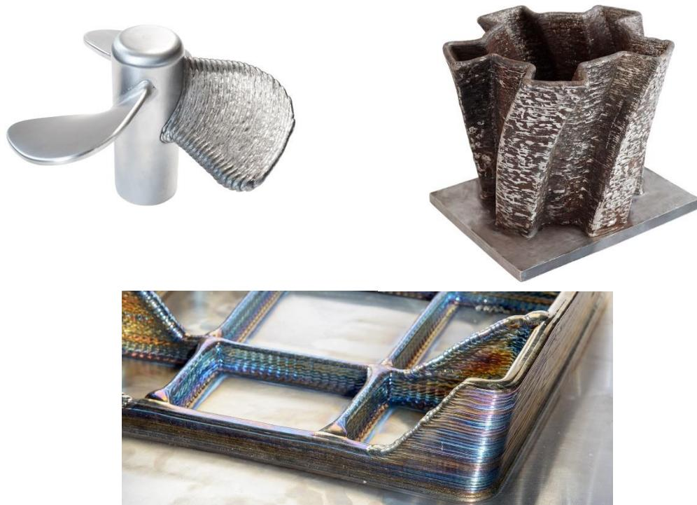
Slika 3.5 Primjeri dijelova izraženih WAAM tehnologijom
