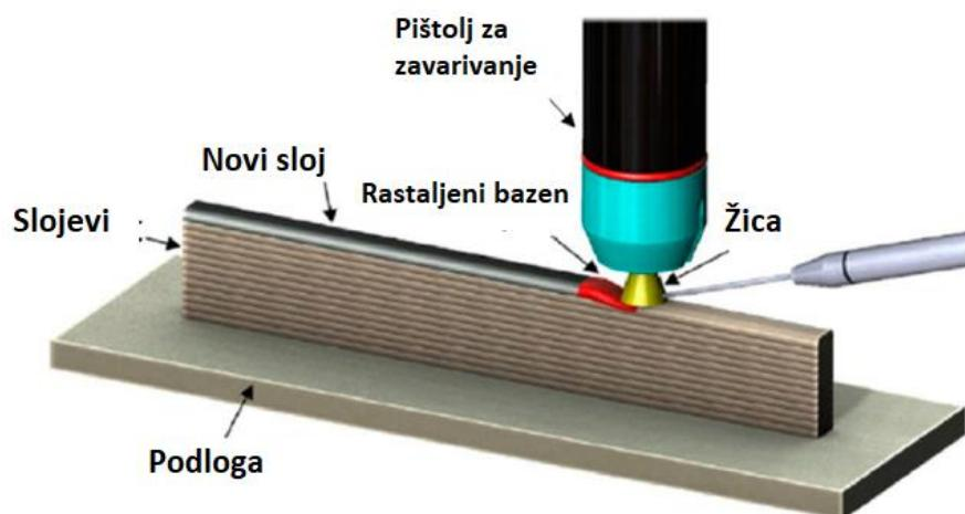
Slika 3.4 Shematski prikaz zavarivanja aditivnom tehnologijom (WAAM)[19]
