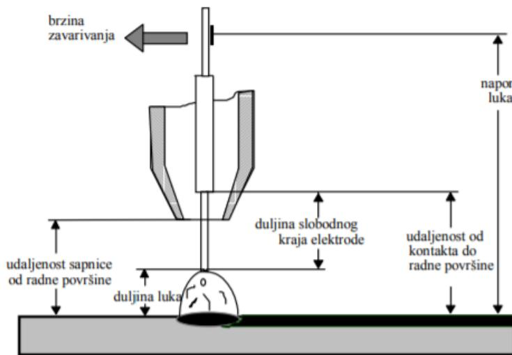
**Slika 3.1 Prikaz osnovnih parametara zavarivanja na primjeru zavara[13]**
