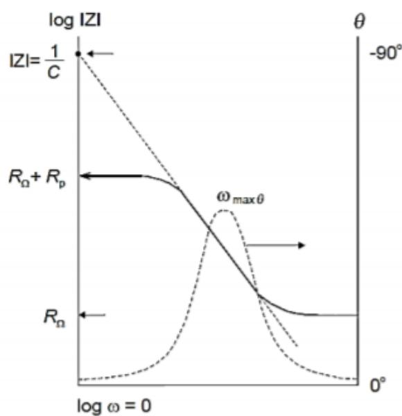
Slika 4.8 Bodeov dijagram jednostavnog elektrokemijskog sustava[24]
