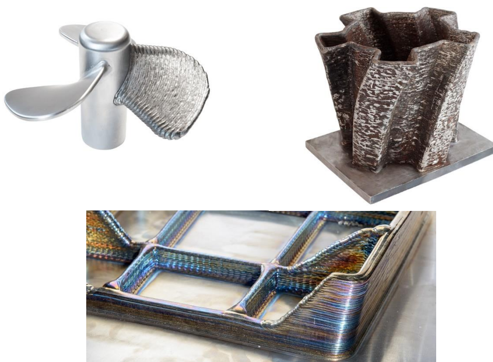
Slika 3.5 Primjeri dijelova izraženih WAAM tehnologijom
