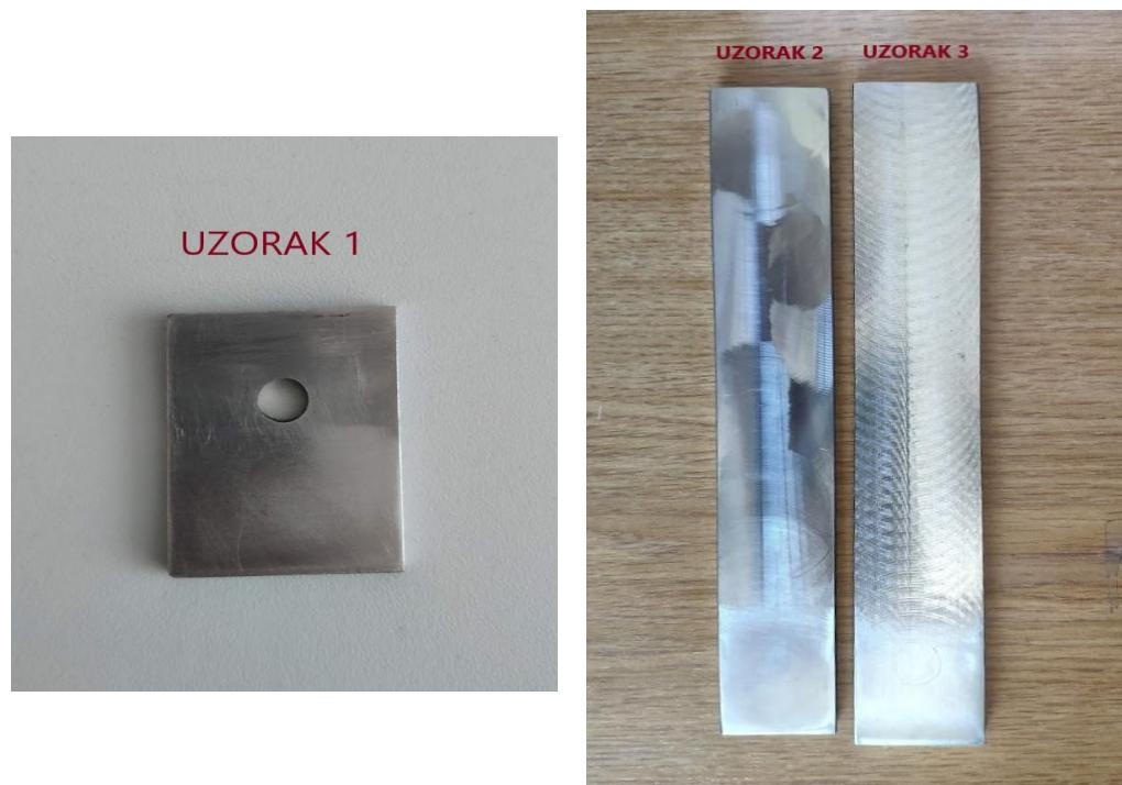
**Slika 5.1 Prikaz uzoraka nakon brušenja površine**
