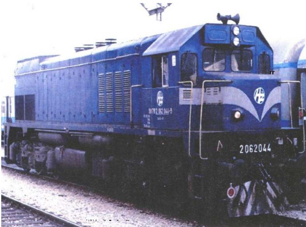
Slika 5. Dizel-električna lokomotiva serije HŽ 2062-000
