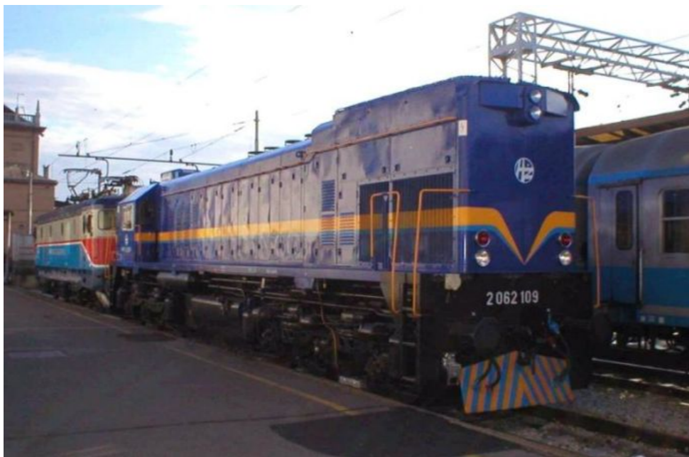
Slika 6. Dizel-električna lokomotiva serije HŽ 2062-100
