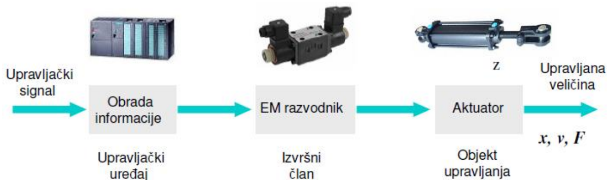
Slika 3. Upravljanje klasičnom hidraulikom korištenjem elektromagnetskog razvodnika [3]
