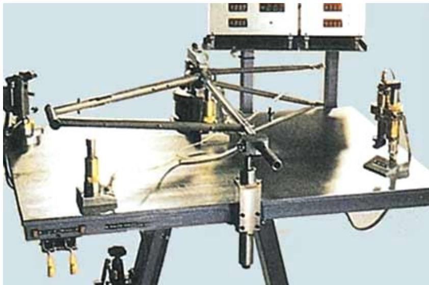
SLIKA 14 - Uređaj za provjeravanje ispravnosti geometrije
