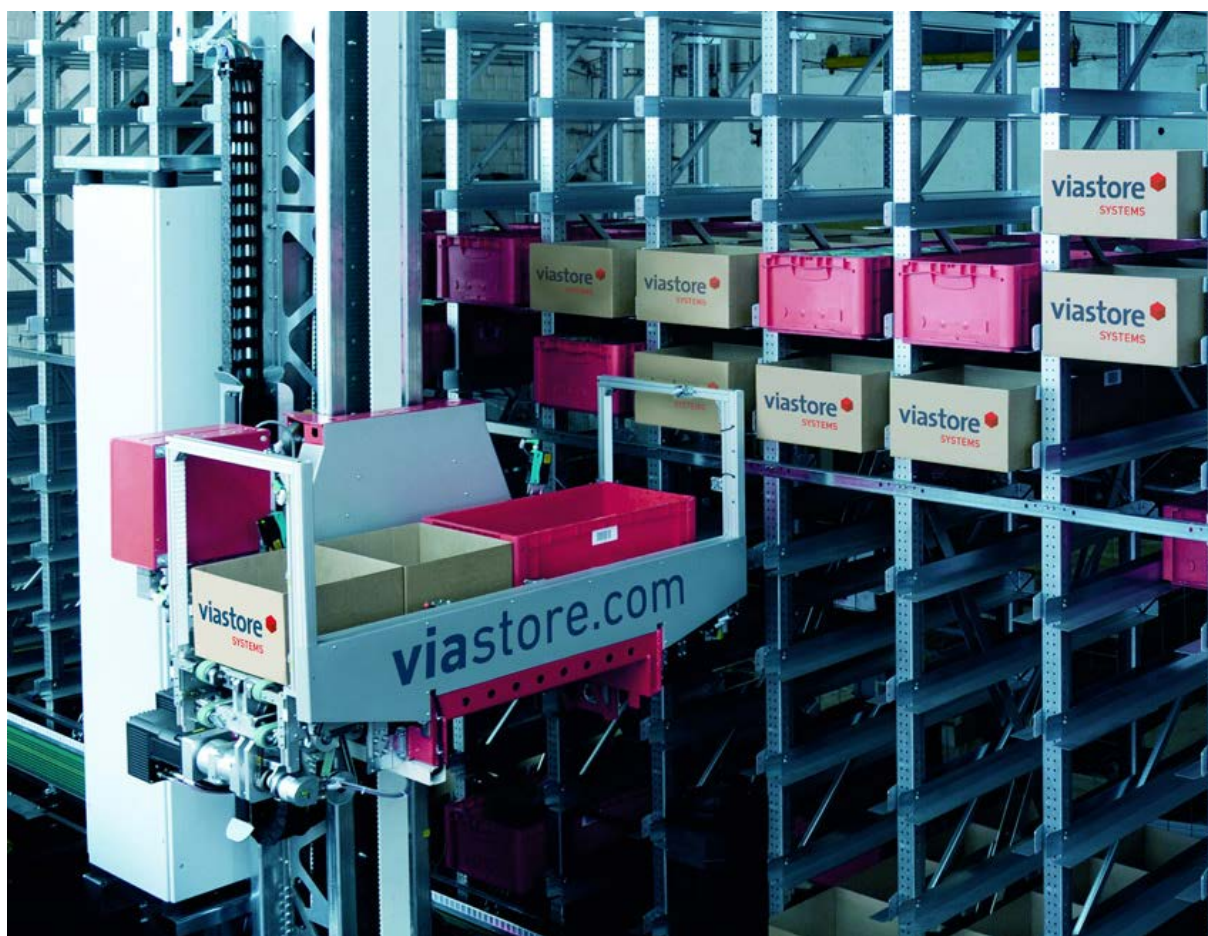
Slika 10. Lift za transport više kutija istovremeno [11]
