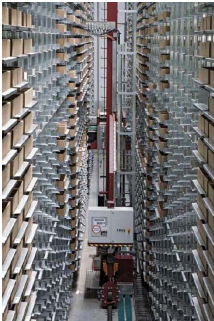
Slika 5. Mini-load sistem implementiran u poduzeće Polar [7]
