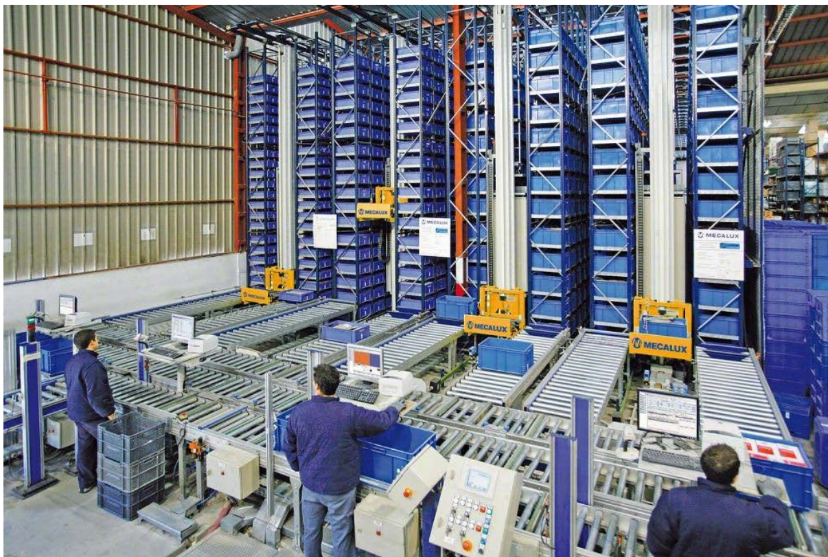
Slika 3. Sustav s konvejerima Mecalux [4]
