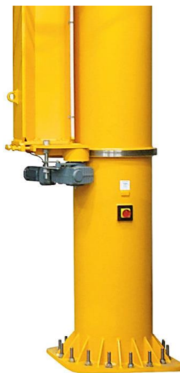
Slika 9. Izvedba vanjskog sprega oslonaca
