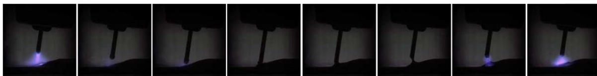
Slika 13. Slijed odvajanja kapljice kod CMT postupka [3]
