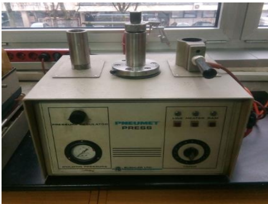
Slika 11. Pneumet press uređaj za vruće zalijevanje uzoraka
