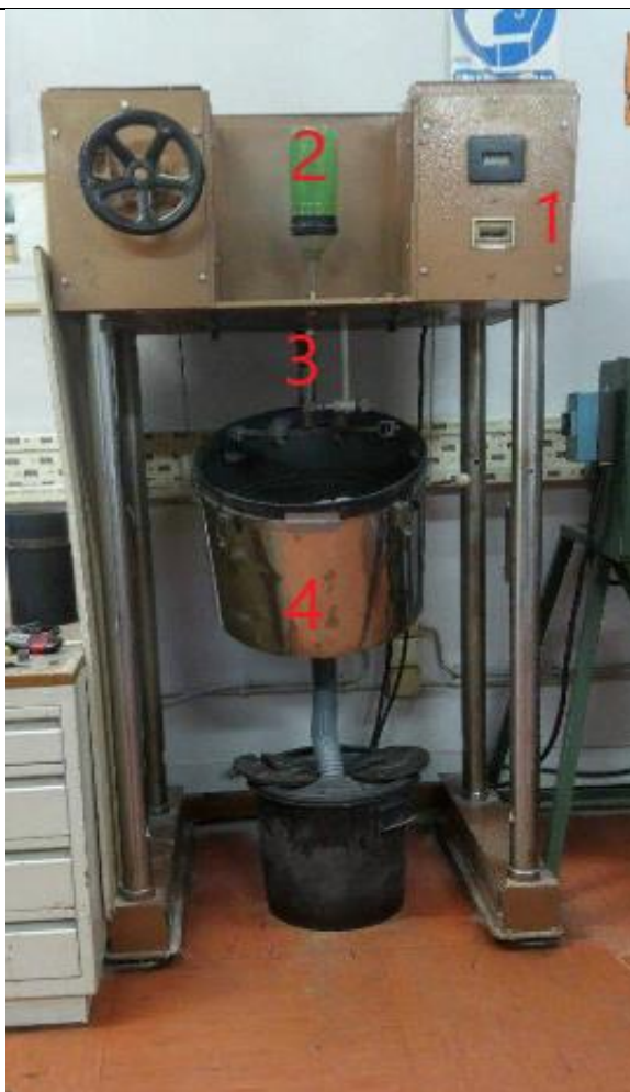
Slika 14. Uređaj za ispitivanje erozije česticama
