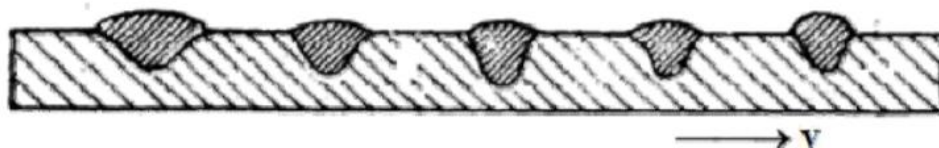
Slika 7. Utjecaj brzine zavarivanja na geometriju zavara [13]
