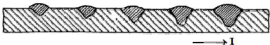
Slika 5. Utjecaj jakosti struje na geometriju zavara [13]
