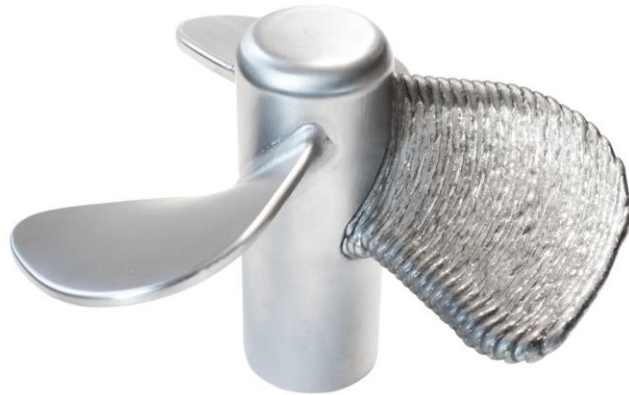
Slika 23. Brodski propeler izrađen WAAM tehnologijom [22]
