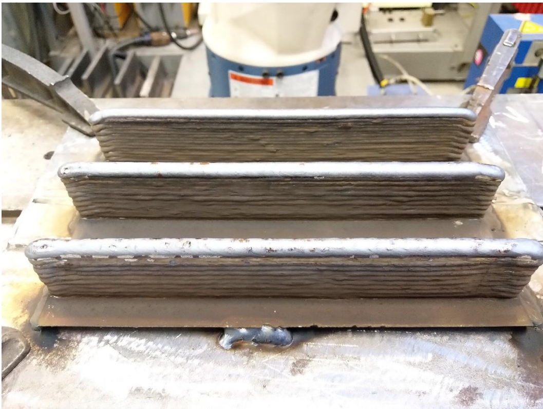
Slika 21. Uzorci izrađeni WAAM postupkom
