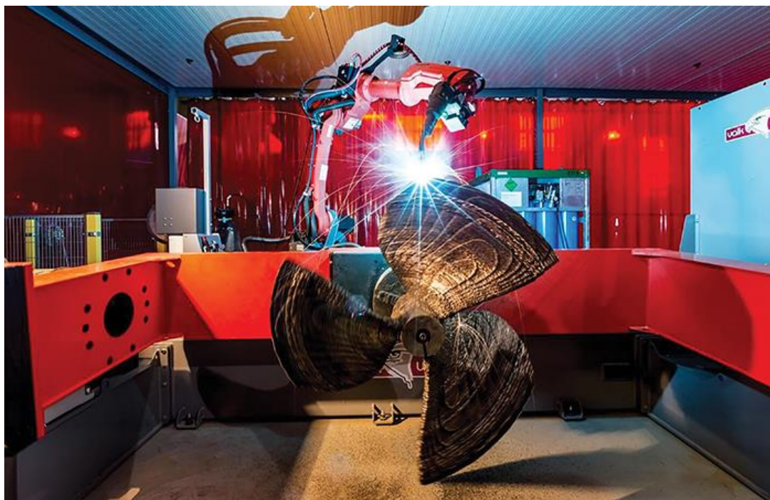
Slika 4. WAAMPeller - brodski propeler izrađen WAAM tehnologijom [8]
