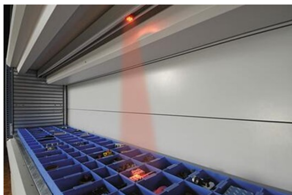
Slika 13. Tehnologija svjetlosne identifikacije lokacije [11]
