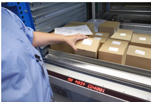
Slika 12. Svjetlom usmjerenom komisioniranje na VLM-u [10]
