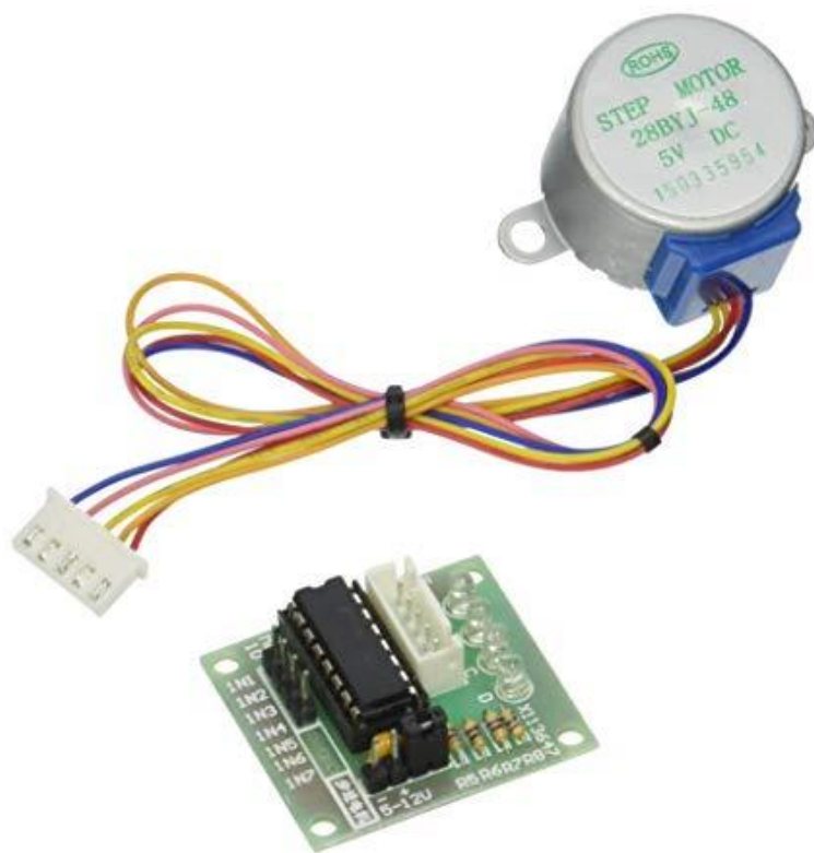
Slika 42. 28BYJ-48 motor s driverom
