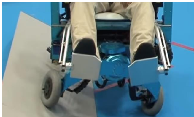
Slika 9. Stabilizacija određene strane vozila
