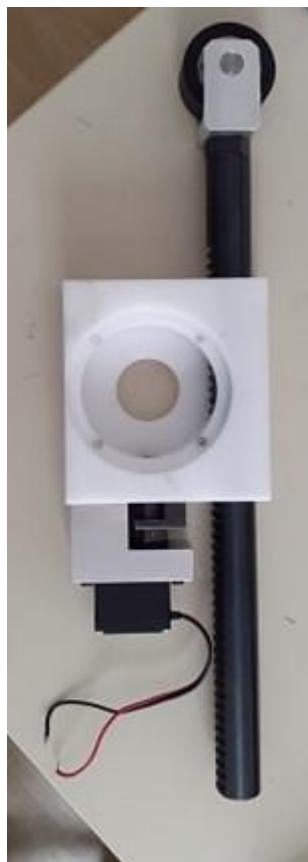
Slika 18. Penjalica sa vanjskim mehanizmom
