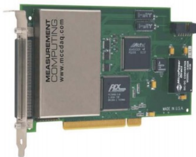
Slika 10. Računalna kartica PCI-DAS6034 [6]
