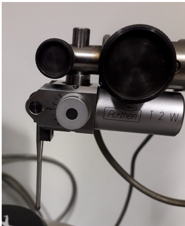
Slika 8. Induktivno ticalo za mjerenje odstupanja od kružnosti
