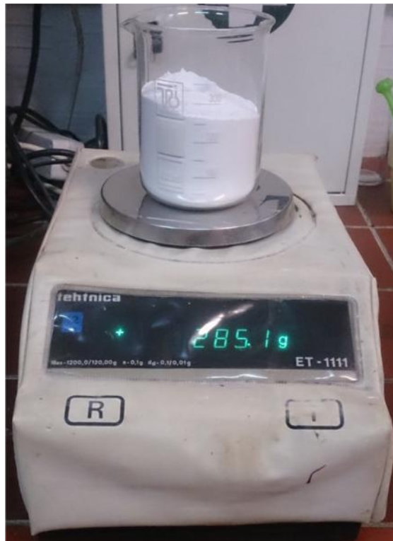
Slika 18. Vaganje mikro \text{Al}_2\text{O}_3 praša
