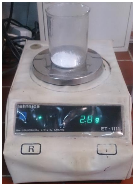
Slika 19. Vaganje nano \text{Al}_2\text{O}_3 praša
