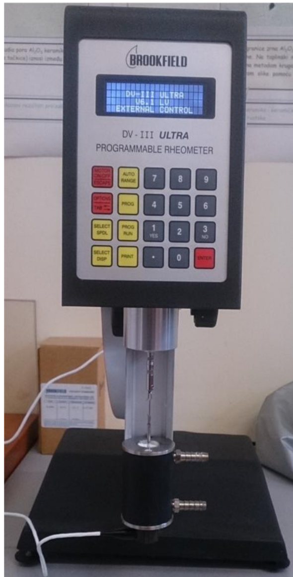
Slika 24. Viskozimetar Brookfield DV-III Ultra
