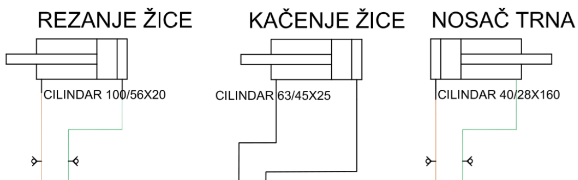
Slika 19. Aktuatorski dio hidrauličkog sustava
