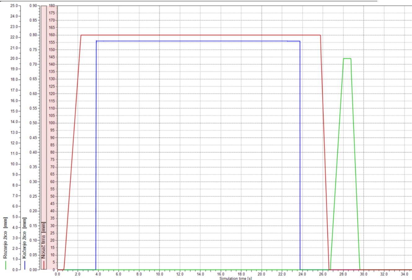
Slika 30. Dijagram gibanja klipova cilindra
