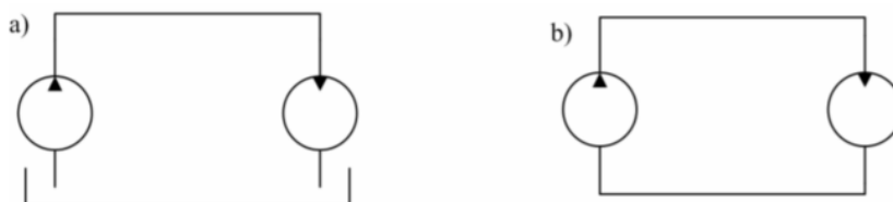
Slika 4. Otvoreni (a) i zatvoreni (b) hidraulički krugovi
