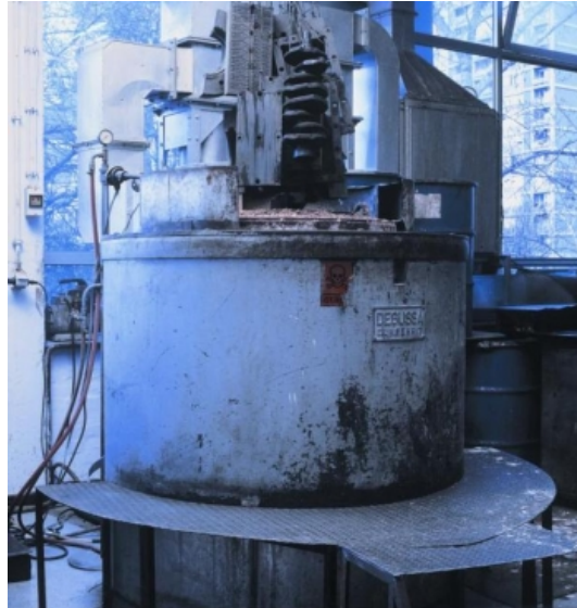
Slika 16. Nitiranje i nitrokarburiranje - radilica motora u solnoj kupci postupkom TENIFER [18]
