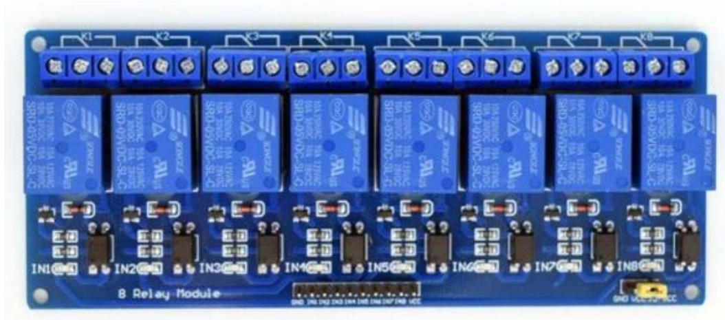
Slika 12. 8-segmentni relejni modul s optokaplerima
