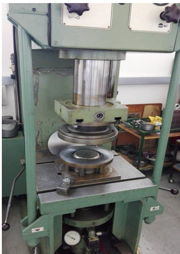
Slika 27. Stroj za duboko vučenje
