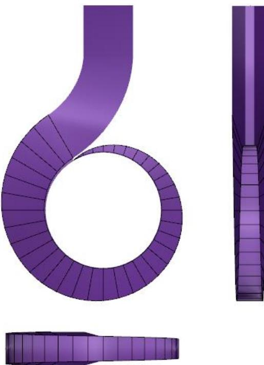
**Slika 19 CAD model trapeznog spiralnog kućišta**
