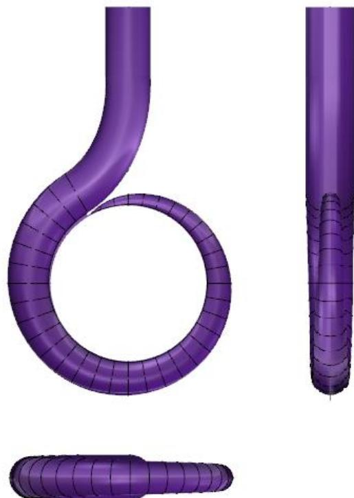
**Slika 16 CAD model kružnog spiralnog kućišta**
