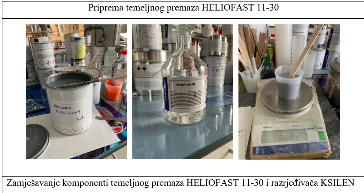
Tablica 7.2.3. Priprema temeljnog premaza HELIOFAST 11-30
