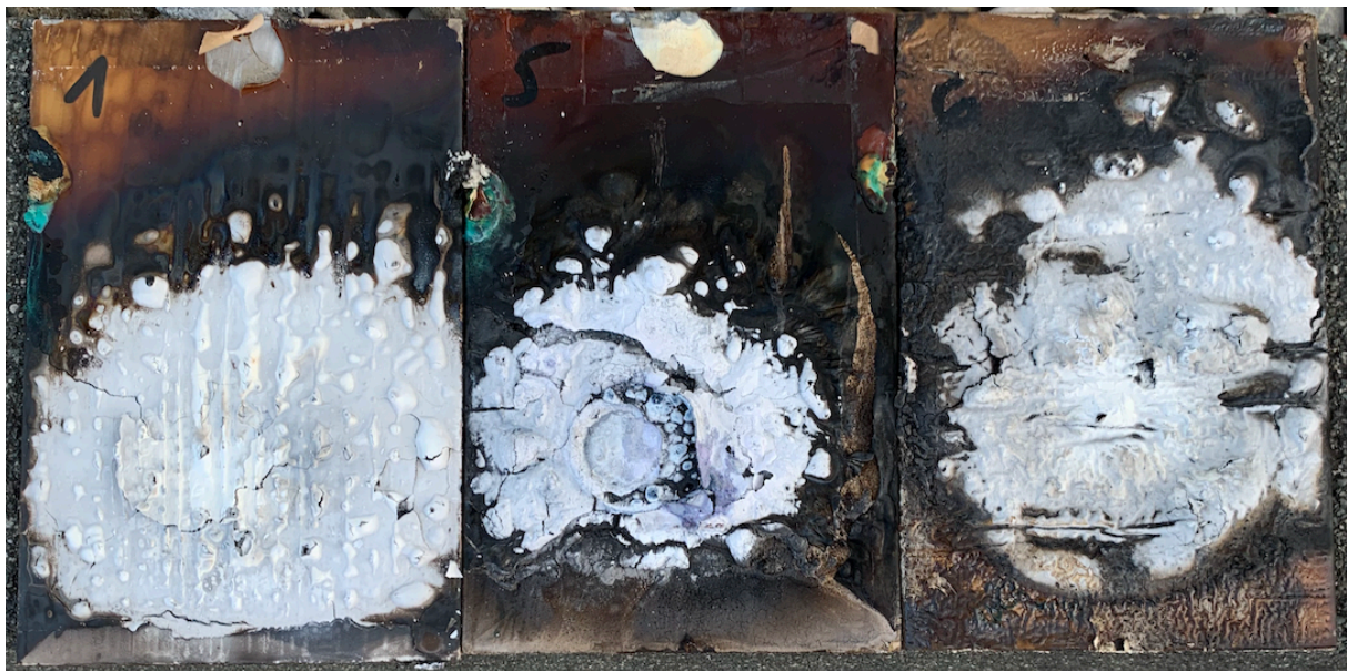
Slika 7.9.4. Izgled uzoraka nakon ispitivanja izlaganja otvorenom plamenu
