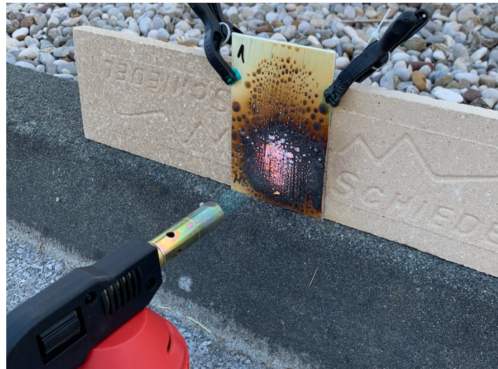
Slika 7.9.3. Gorenje uzorka broj 1.
