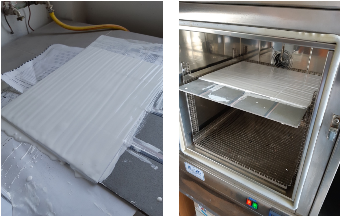
Slika 7.3.2. Nanošenje i sušenje premaza PROMAPAINTE SC4 Klase R60
