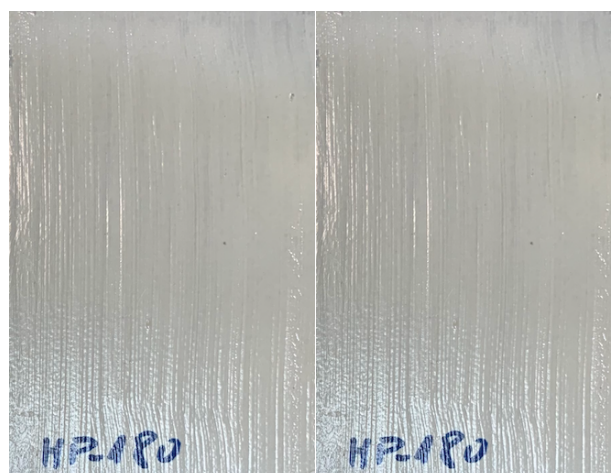
Slika 7.8.3.1. Ispitivanje mjehuranja površine premaza prije i slane komore
