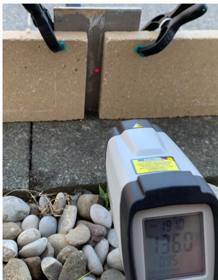
Slika 7.9.2. Mjerenje prirasta temperature pozadine uzorka pirometrom
