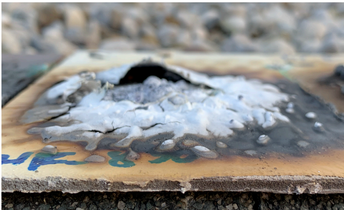
Slika 7.9.5. Ekspanzija vatrootpornog premaza uzorka 5.
