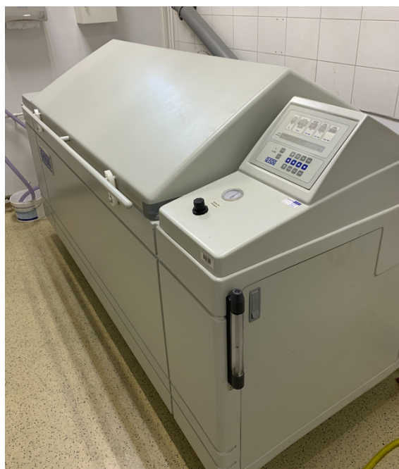
Slika 7.5.1. Slana komora, HELIOS Slovenija
