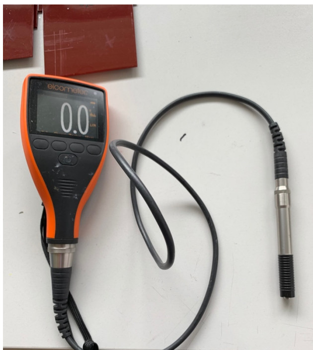
Slika 7.2.2. Uređaj za mjerenje debljine suhog filma „ELCOMETER 456“
