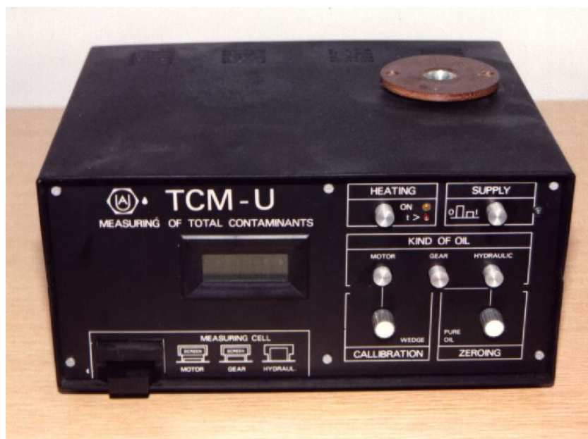
Slika 5.7 - Uređaj za mjerenje zagađenja ulja TCM – U
