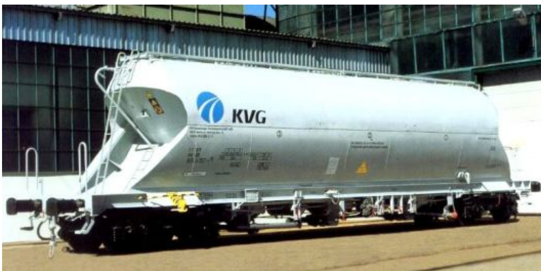
Slika 2.6 - Željeznička cisterna za transport UNP-a [8]
