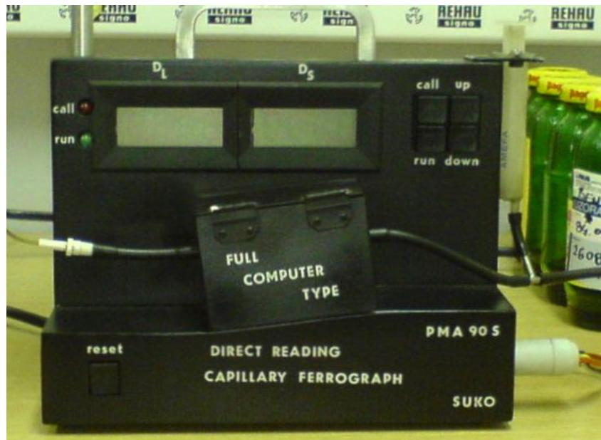
Slika 5.6 - Ferograf s direktnim očitanjem PMA 90 S
