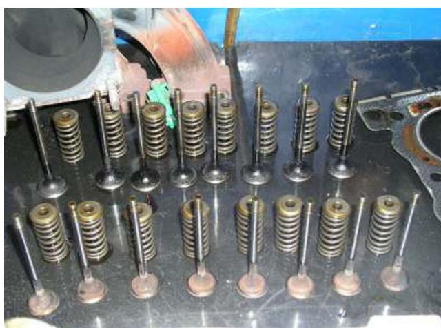
Slika 5.4 – Ventili motora testnog vozila
