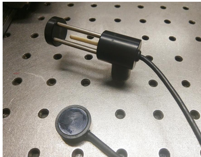
Slika 47 Senzori okolišnih uvjeta sustava Renishaw ML10
