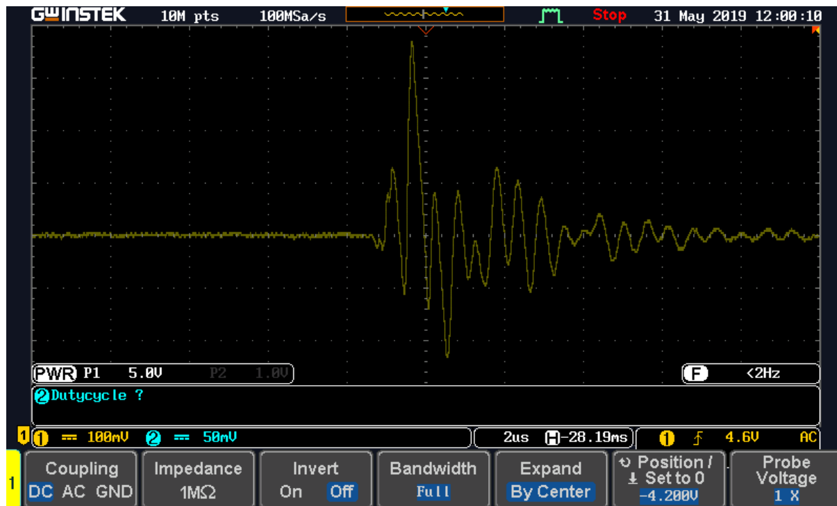
Slika 57 Primjer distorzija na izlazu operacijskog pojačala
