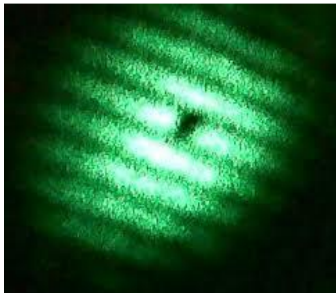
Slika 8 Interferencijske pruge vidljive na zaslonu Twyman-Greenovog interferometra [11]
