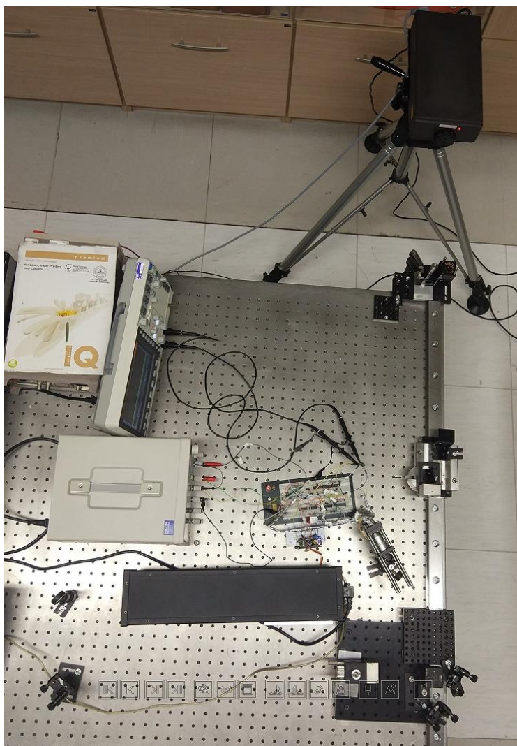
Slika 50 Postav provedenog usporednog mjerenja interferometara
